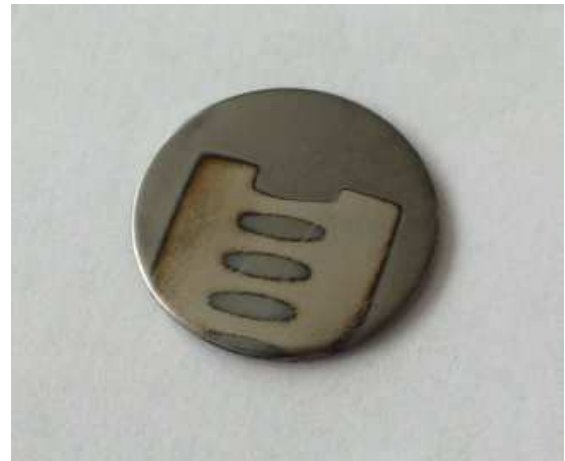
3D Fähigkeit KiCoat beschichteter Oberflächen: Prüfkörper aus hinterschnittiger Kontur entnommen
