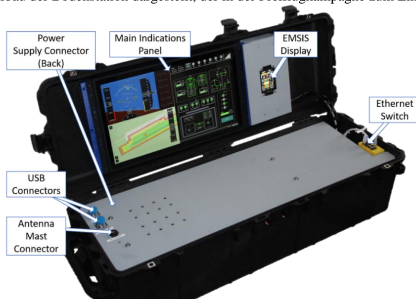
Abbildung 6-49: Realisierter Aufbau der mobilen Bodenstation für Schwebegestell und Freiflugtests.
