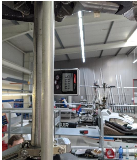
Abbildung 6-5: Vertikale Ausrichtung des Rotormastes als Basis für die Kalibrierung aller Einbau- und Steuerwinkel
