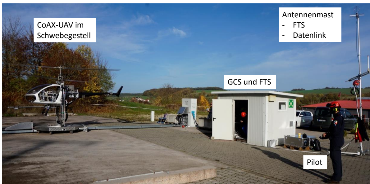
Abbildung 6-62: Versuchsaufbau bei der Erprobung am Schwebetrainer.
