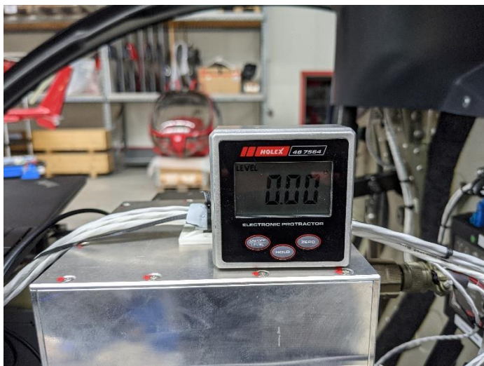
Abbildung 6-9: Vermessung der Einbauwinkel bestimmter Sensoren (links: Winkelbeschleunigungssensor, rechts: Inertialsensor)
