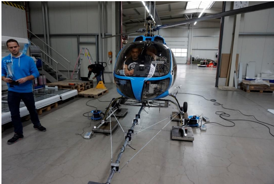
Abbildung 6-11: Wägung des Hubschraubers mit integriertem Messsystem mit Ermittlung der Schwerpunktslage in x- und y-Achse durch die vier Gewichtsaufnahmepunkte
