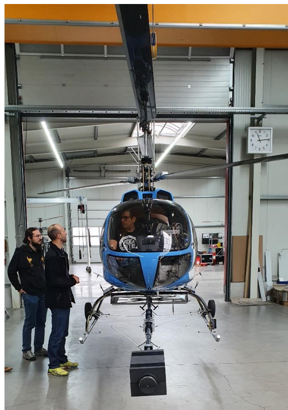
Abbildung 6-10: Aufbau des Schwingversuches zur Bestimmung der z-Komponente des Schwerpunktes sowie der Einbauorte relativ zum Schwerpunkt der Inertialsensoren und des rotatorischen Trägheitsmomentes des Hubschraubers
