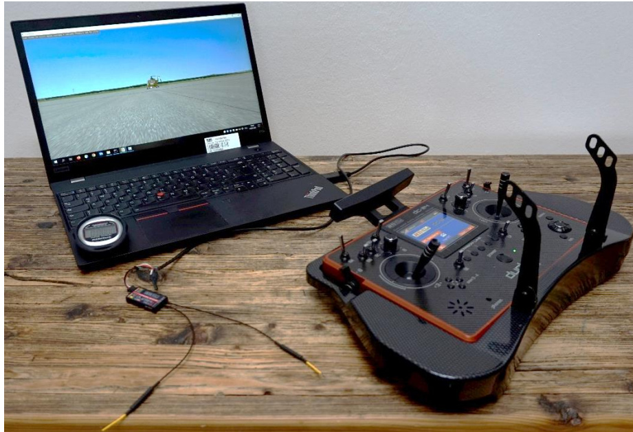
Abbildung 6-20: Mobiler Simulator zum flexiblen Pilotentraining mit original Empfänger und Fernsteuerung im Loop
