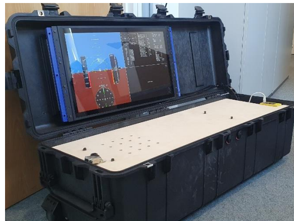
Abbildung 6-48: Realisierter Aufbau der Engineeringstation zu Beginn der HIL-Tests (li: Konstruktion, re: echte Hardware)
