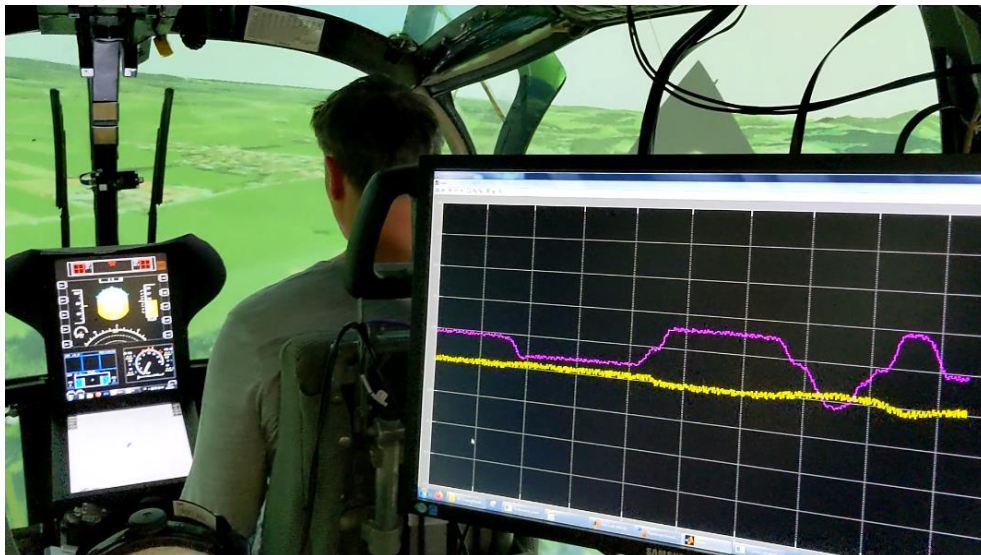
Abbildung 6-12: Dynamisches Manöver (3-2-1-1) im Flugsimulator ROSIE des Lehrstuhls für Hubschraubertechnik (TUM)
