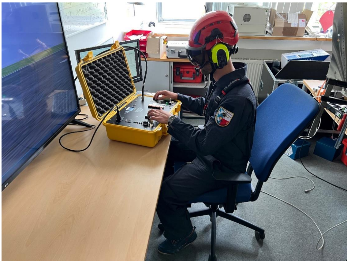
Abbildung 6-53: Flugabbruchsystem in der HIL Simulationsumgebung.
