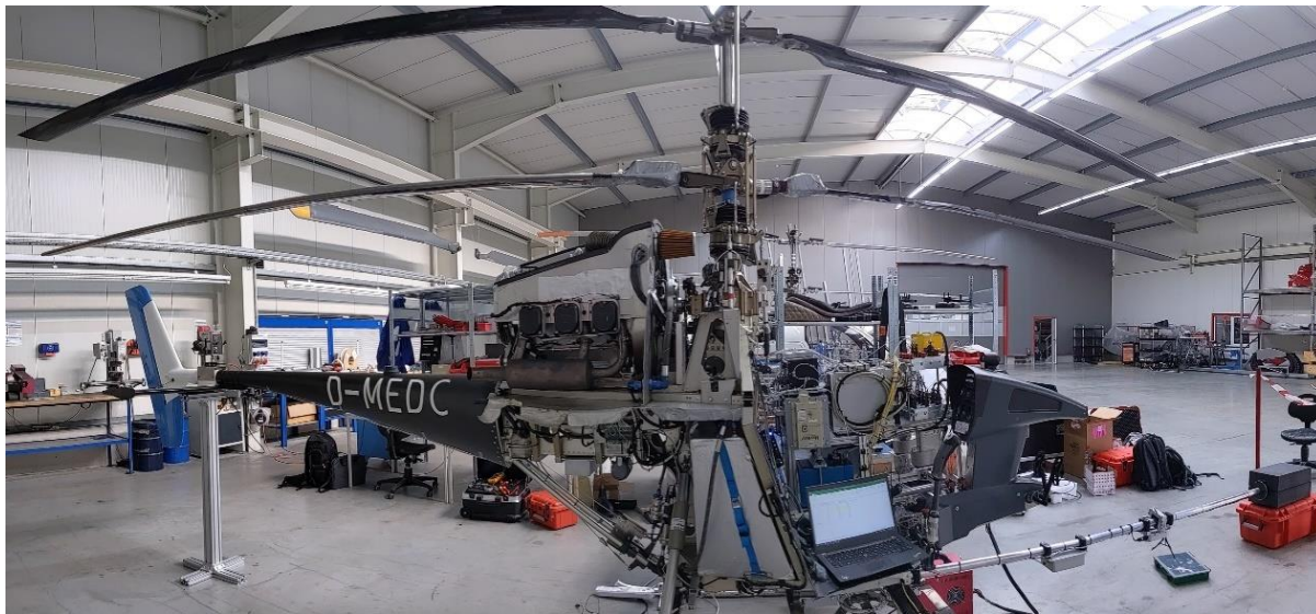
Abbildung 6-4: Integration des Messsystems in das Fluggerät
