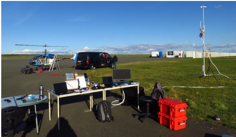
Abbildung 6-13: Setup für die Identifizierungsflüge mit instrumentiertem Hubschrauber, Antennenmast mit Wetterstation und der Bodenstation mit Datendisplay, Dokumentationsbrett und Funkgerät zum Einspielen des Audio-inputs und der Kommunikation mit dem Piloten
