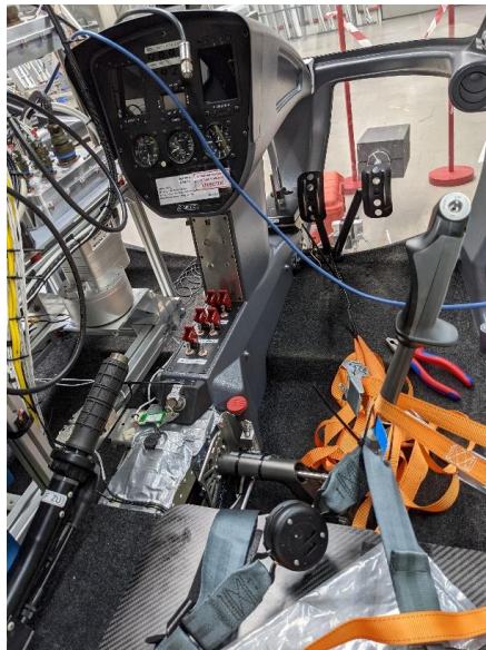
Abbildung 6-8: Vermessung der Rotorblattwinkels bei verschiedenen Steuereingaben (links: Fixierung der Steuerorgane, rechts: Blattwinkelmessung an r=0,7 über mehrere Umlaufwinkel)
