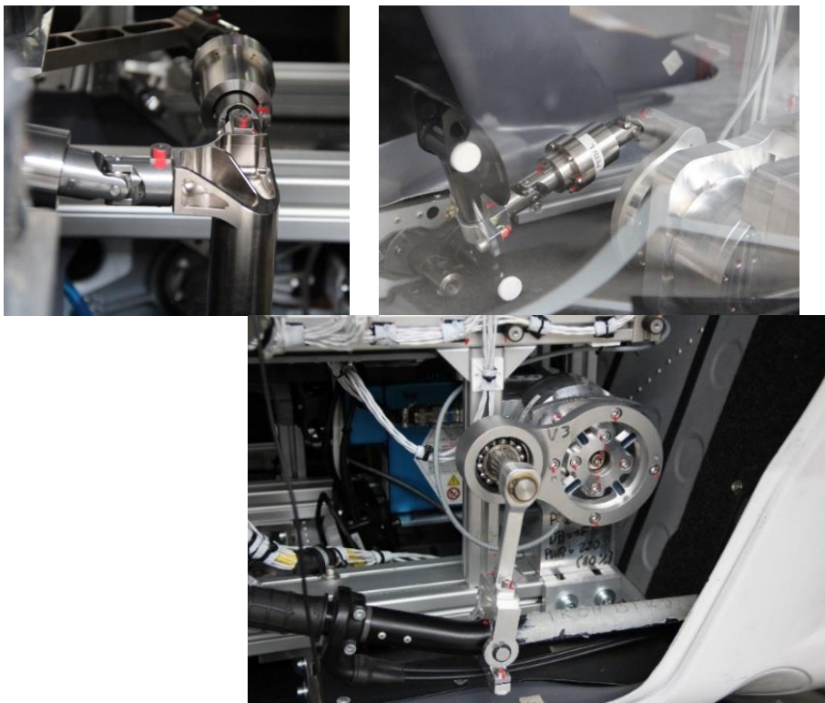
Abbildung 6-59: Finale Ausführung der Aktuatoranbindung an die Steuerorgane.
