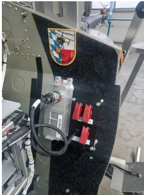
Abbildung 6-39: Im CoAX600-UAV integrierte Optokoppler-Box.
