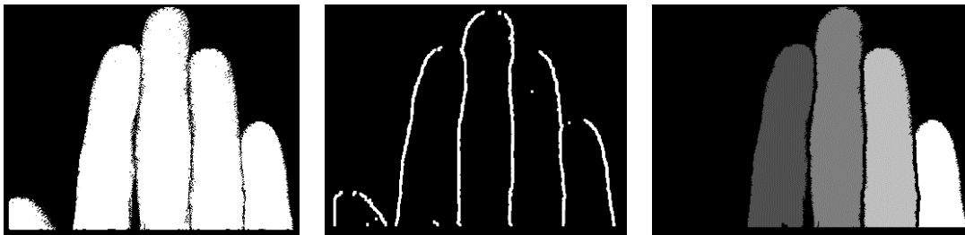
Abbildung 14 von links nach rechts: Maske der 3D-Daten, segmentierte und markierte Finger Grenzen und Finger (Datensatz aus Messkampagne 02.10.2020)
