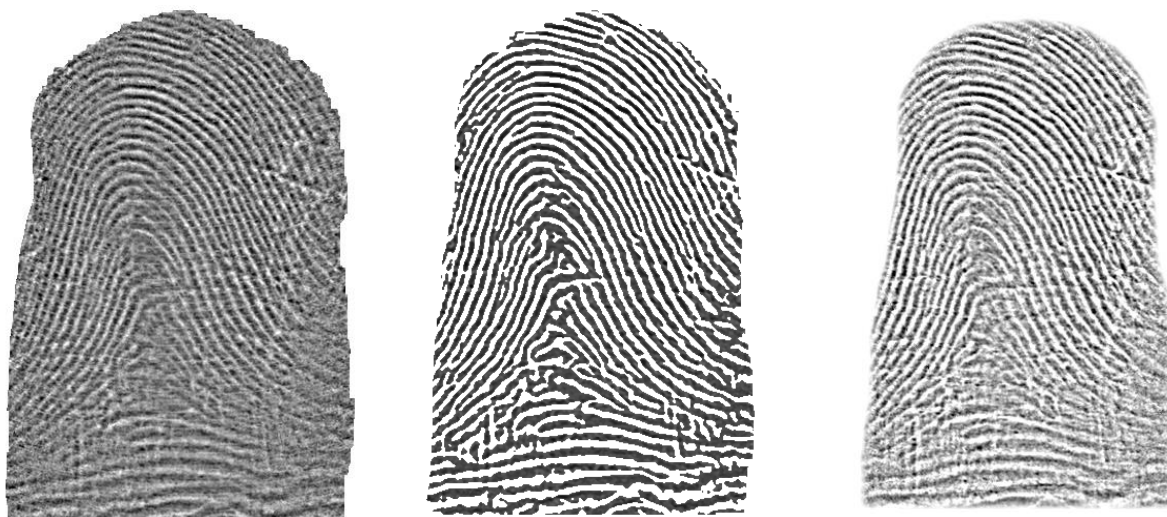
Abbildung 6 Ergebnisse der Pixelwerttransformation: ohne Manipulation der Höheninformation (links), mittels lokal ermittelter Schwelle ausgeblendete Gräben (mitte), histogrammbasiertes adaptives Clipping der Höhenwerte (rechts)
