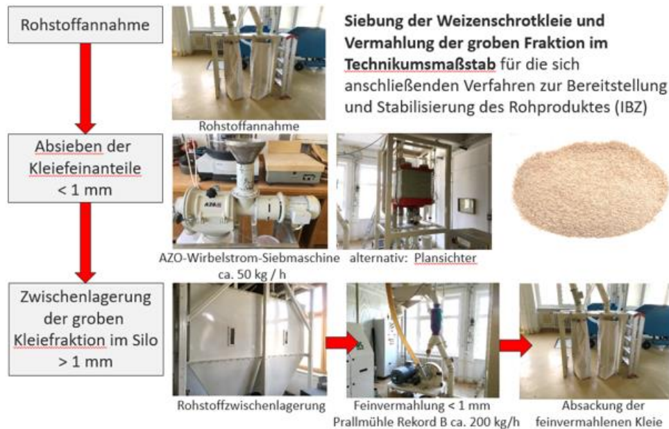
Abbildung 19: Scale-up aus dem Labor- in den Technikumsmaßstab / Rohstoffaufarbeitung.
