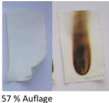
Abbildung 37: Baumwolle beschichtet mit einer Handraker (100 µm) mit Polyvinylammoniumphytat nach fünfmaliger Wäsche vor (links) und nach (rechts) dem Flammtest.
