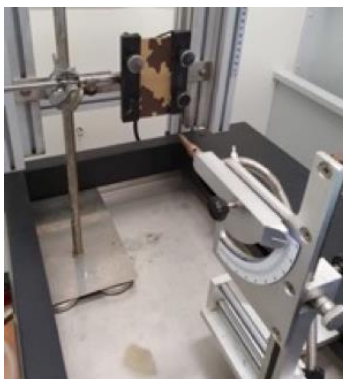
Abbildung 50: Flammtestgerät GT-E01 der Firma GESTER Instruments Co., Ltd.
