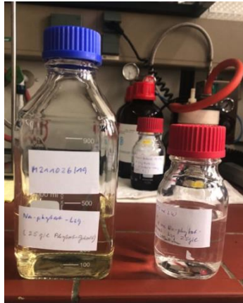
Abbildung 82: Eingesetzte Phytatlösung und resultierende Phytat/Leitungswasser-Mischung; links: 25 g/l Natriumphytat-Lösung (gemäß IUTA-Verfahren synthetisiert), rechts: Gemisch Phytat/Leitungswasser (8 ml Phytatlösung/100 ml Leitungswasser).
