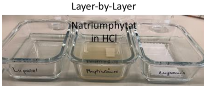
Abbildung 26: Hergestellte Lösungen für die Layer-by-Layer-Ausrüstung von Baumwolle mit Natriumphytat als Weizenextrakt.
