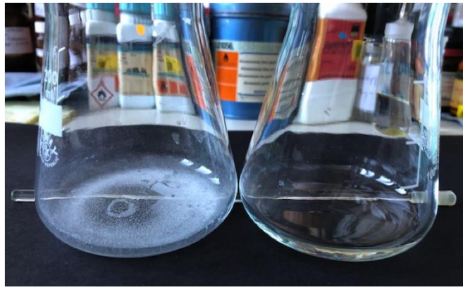
Abbildung 80: Resultat eines vergleichenden Kochtests (links: kein Phytinsäurezusatz; rechts: Zusatz von 300 µl 50%iger Phytinsäure zu 100 ml Rheinhausener Leitungswasser).
