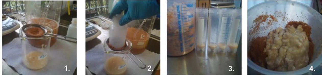
Abbildung 11: Extraktionsrückstand von Weizenkleie nach Filtration und Zentrifugierung.
