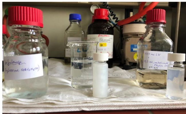
Abbildung 81: Zusatz von Seifenlauge zu Rheinhausener Leitungswasser (links: kein Phytatzusatz; rechts: 0,3%-iger Zusatz von ca. 50%-iger Phytatlösung zum Leitungswasser).
