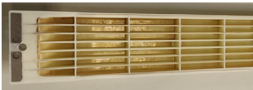
Abbildung 15: Demonstrator mit Metalleinlegern
