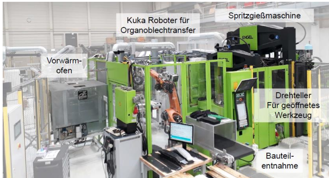
Abbildung 13: Anlagensystem zur Herstellung des Demonstrators an der TU Chemnitz
