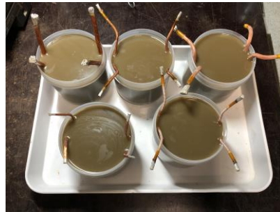
Abbildung 9: Versuchsaufbauten mit verschiedenen verdrehten Litzen und Vergüssen
