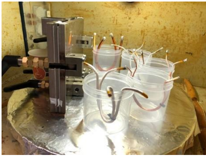
Abbildung 9: Versuchsaufbauten mit verschiedenen verdrehten Litzen und Vergüssen
