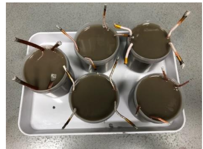
Abbildung 9: Versuchsaufbauten mit verschiedenen verdrehten Litzen und Vergüssen
