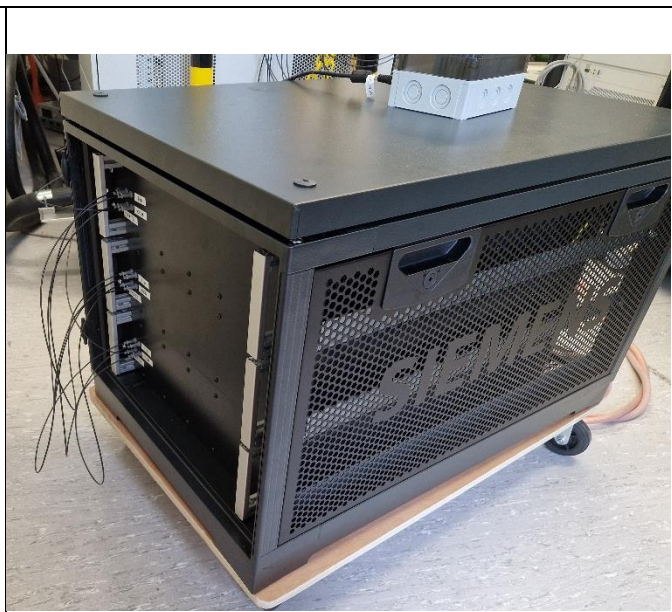
Abbildung 31: Finales Gehäuse des DC//DC Wandlers mit allen drei Doppelsubmodulen
