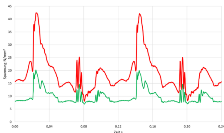
Abbildung 42: Spannungsergebnisse aus dem Experiment über vier Umdrehungen der Kurbelwelle bei 75% Last mit maximaler Spannung von 43 N/mm 2 .
