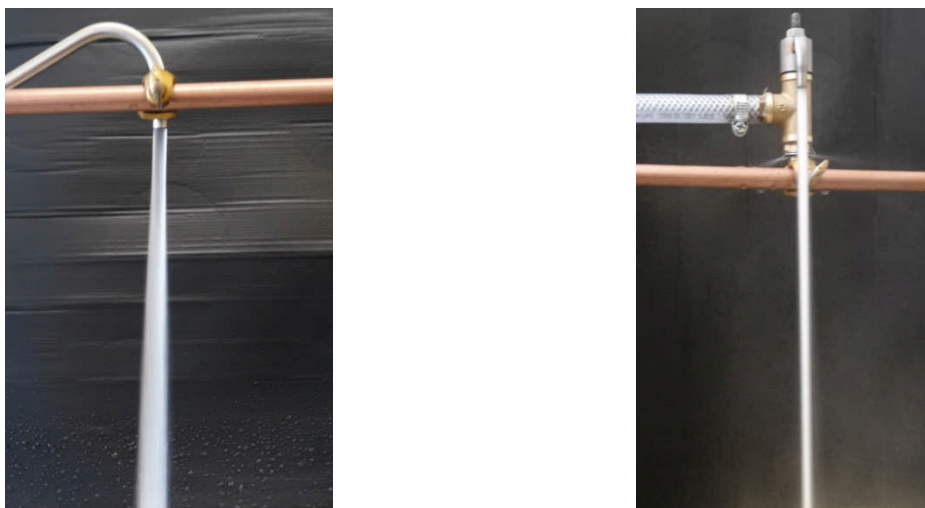
Abbildung 5: Visualisierung der Ausbreitung des Freistrahls auf dem Prüfstand der MET GmbH: links - Düse mit konstantem Querschnitt, rechts - Düse aus dem Projekt SimShaker
