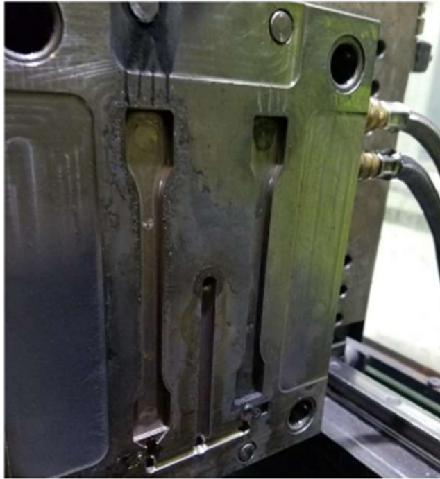
Abbildung 7: Prüfkörper-Werkzeug zur Erstellung der Alterungs-Durchläufe
