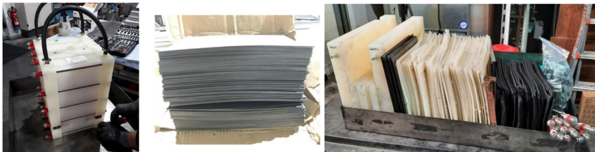
Abbildung 42: Gebrauchter Redox-Flow-Stack (20 Zeller), Ausschuss-BPP, Demontierter Stack
