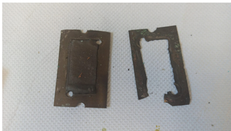
Abbildung 25: Zersetzung der Bipolarfolie (zweifach recyceltes Material) nach der Aufprägung von 100 mA/cm 2 .
