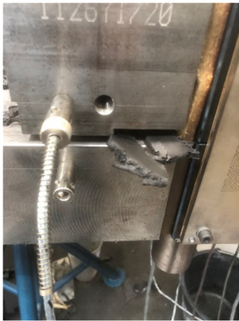
Abbildung 19: Compound welches an der Werkzeugseitenwand austritt und verjüngte 8.8 Schrauben
