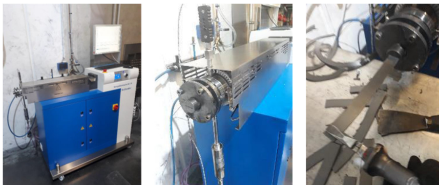
Abbildung 46: Inbetriebnahme Einschneckenextruder mit Strangdüse (20x2 mm 2 )
