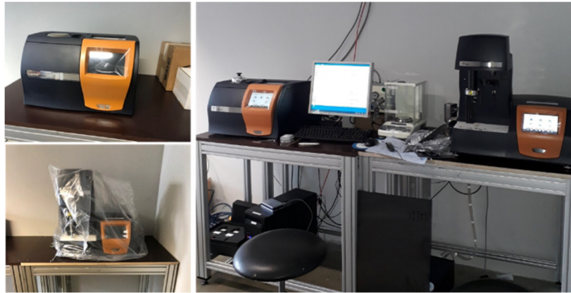
Abbildung 50: Beschaffte Messgeräte DSC, TGA zur Untersuchung hochgefüllter Compounds
