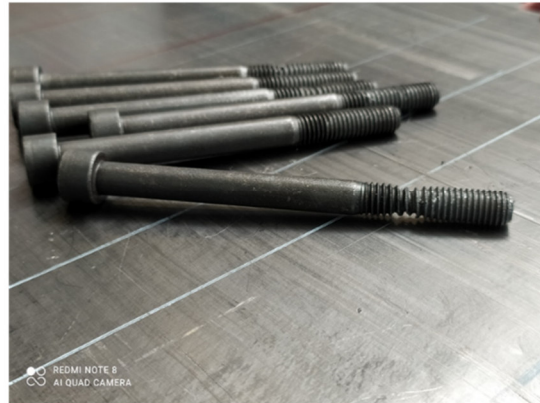
Abbildung 19: Compound welches an der Werkzeugseitenwand austritt und verjüngte 8.8 Schrauben
