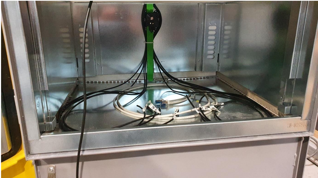
Abbildung 3-41 - StrainLock – Einlegen der Datenkabel
