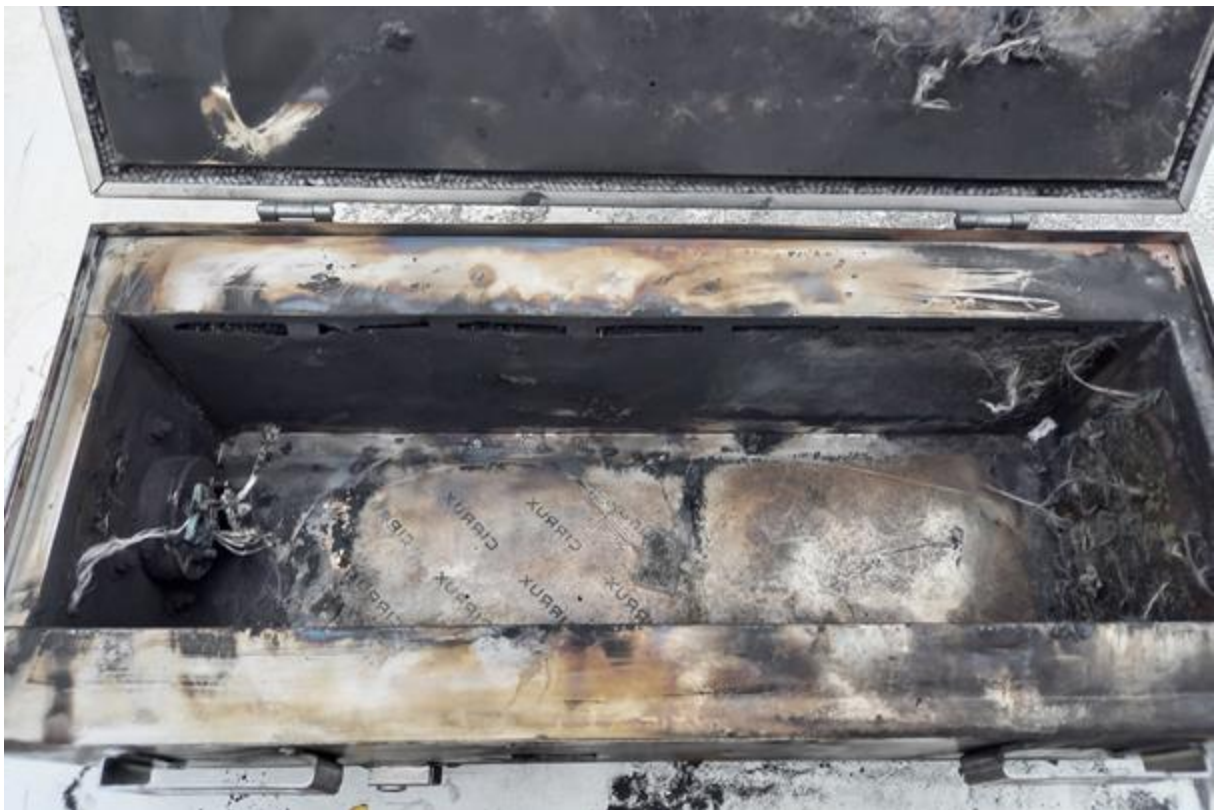
Abbildung 3-68 - StrainBox nach Brandversuch mit geleertem Innenraum
