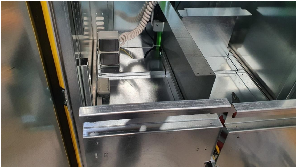
Abbildung 3-39 - StrainLock - Fach mit Steckdosen
