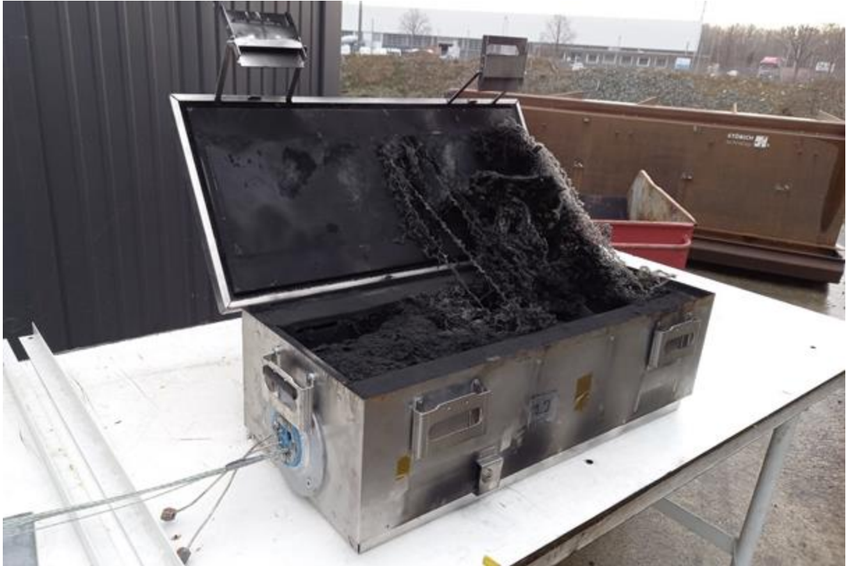
Abbildung 3-67 - StrainBox nach Brandversuch
