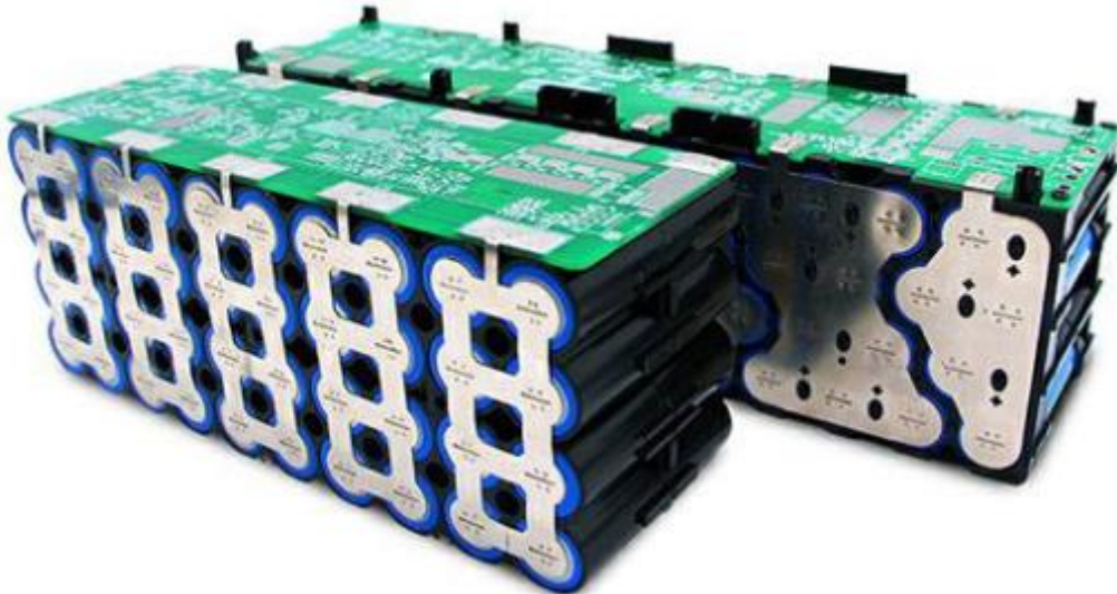
Abbildung 3-54 - Zwei Akkupacks mit BMS, Kontaktierungsblechen und Kunststoffgittern [30]
