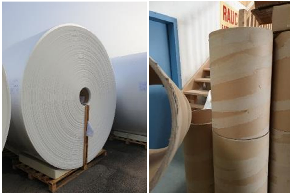
Abbildung 46. Kartonagerollen in ursprünglicher Benutzung zur Lagerung von Kunststoffolie (linke Abbildung) sowie im Rohzustand mit abgelöster Kunststofffolien-Klebstoff-Schicht inkl. resultierender Schäden am Kartontagekorpus (rechte Abbildung).
