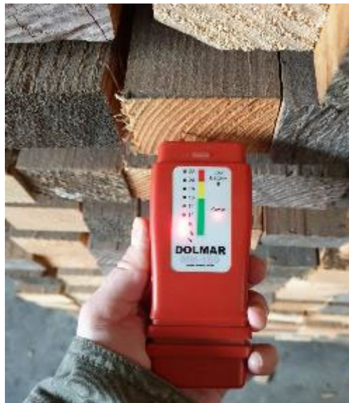
Abbildung 44. Holzfeuchte-Messgerät der Firma DOLMAR in Benutzung bei der Datenerfassung am 2021-10-29, Holzwerkstatt AQA gGmbH, Neunkirchen.
