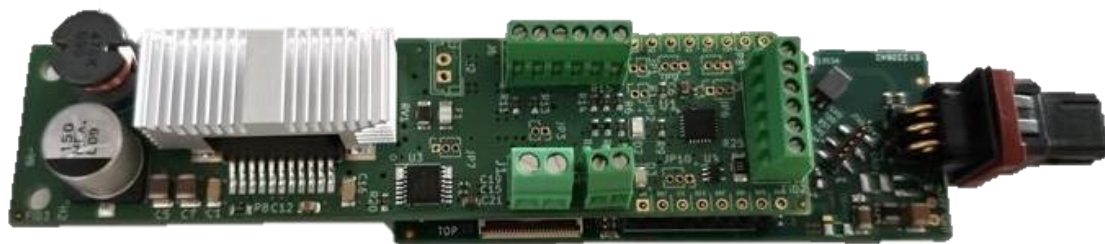
Figure 10: ZAL Endpoint mit aufgesteckter Platine zur Anbindung von LED-Beleuchtung
