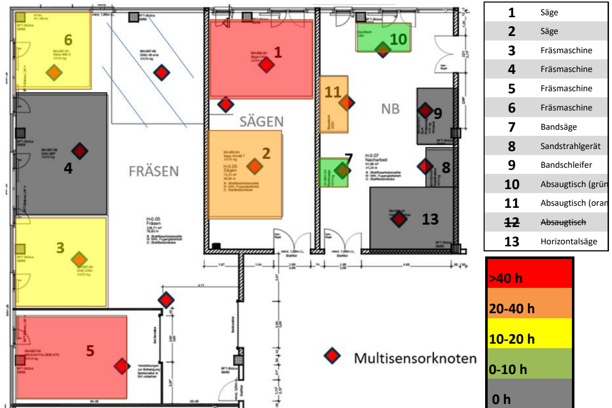
Abbildung 9: Position der Sensorknoten mit Betriebsstunden der Maschinen
