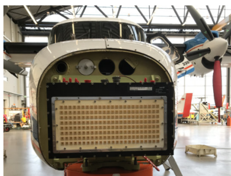
Abbildung 36: Integration der DAA Radar Antenne und Lage der DAA Systemkomponenten in der Do 228
