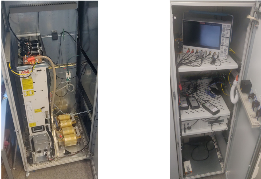
Abbildung 5: Demonstrator zur Durchführung der Versuchsreihen (links Versuchsumrichter ACS880 und Lastdrossel, rechts: Messtechnik und Spannungsversorgung)
