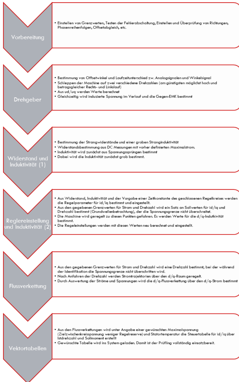
Abbildung 5 Vorgehen zur Inbetriebnahme des IEM Motors und Entwicklung der Regelung.
