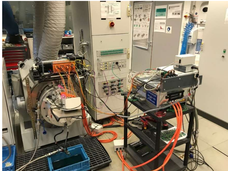
Abbildung 13: Prüfstand für elektrische Maschinen von Hybrid-Fahrzeugen von Mercedes-Benz
