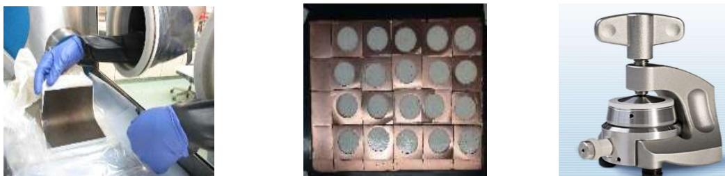
Abbildung 9: Präparation der Elektroden und verwendete Drei-Elektrodenzellen
