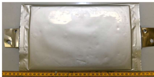
Abbildung 7: Gealterte Pouch Zelle
