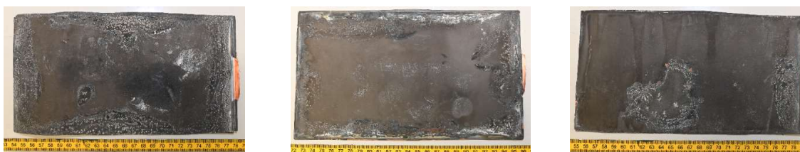
Abbildung 8: Exemplarische Anodenlagen verschiedener gealterter Zellen
