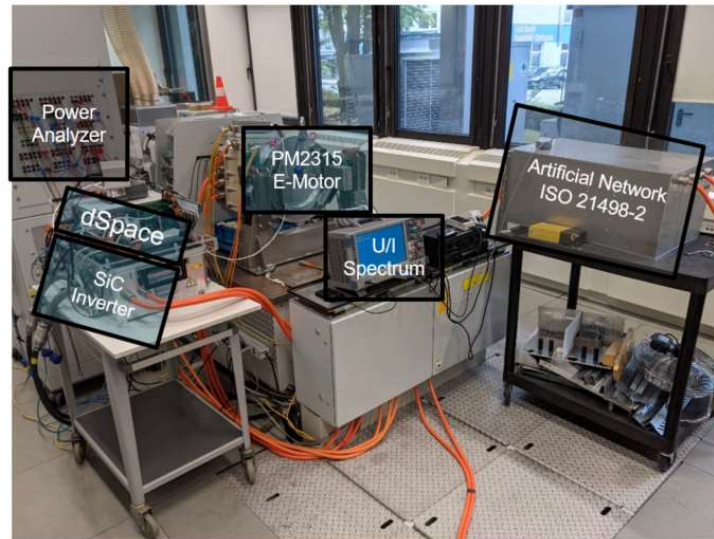
Abb. 14: Prüfstands Aufbau am Maschinenprüfstand bei Mercedes-Benz
