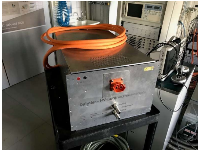
Abbildung 17: Bordnetznachbildung der Mercedes-Benz AG
