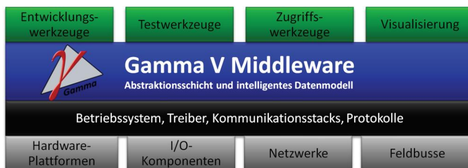
Abbildung 10: Aufbau eines Systems mit der Middleware GammaV
