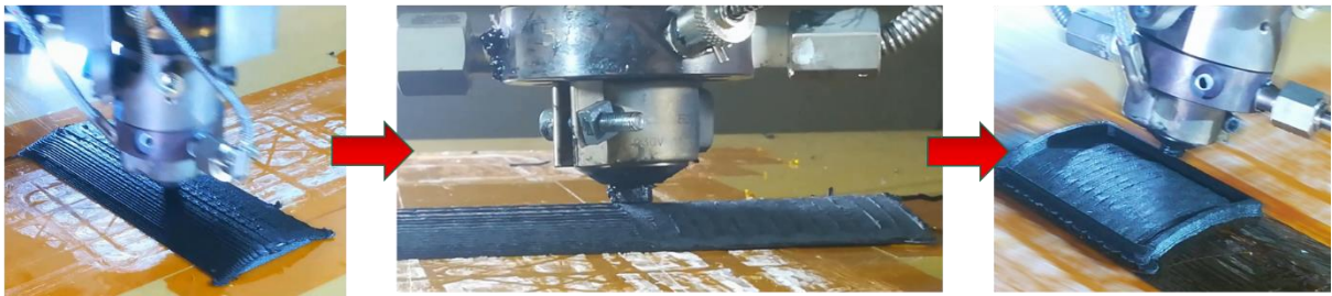
Abbildung 2: Prinzipdarstellung des Heißglättens mittels Extruderdüse
