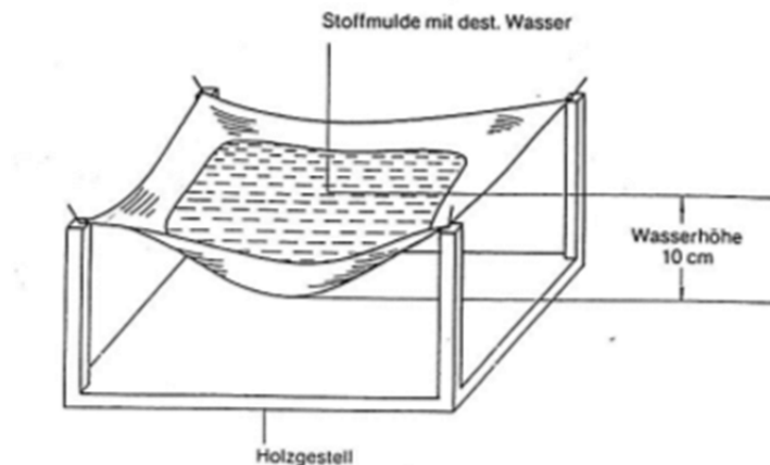
Abbildung 26: Schematische Zeichnung zum Aufbau des Muldenversuches
