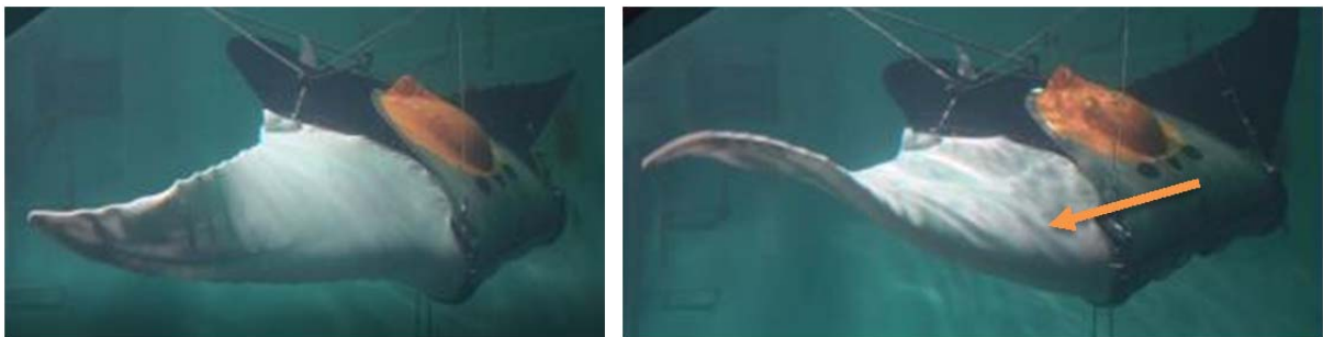
Abbildung 19: Testszenario des Mantas mit textiler Außenhaut im Wasserbecken
