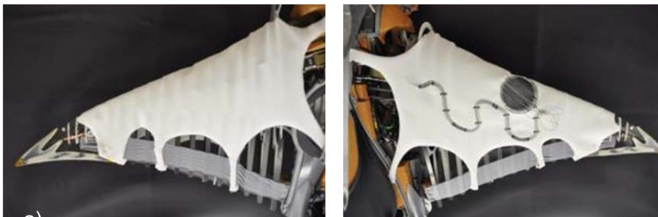
Abbildung 54: Teilbereiche der funktionellen Innenhaut a) Unterseite; b) Oberseite mit textilem Kabelbaum und kapazitiven Berührungssensoren
