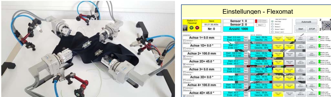
Abbildung 66: Flexomat mit eingespanntem Prüfling
