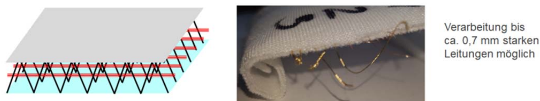
Abbildung 31: Verlegte isolierte, elektrische Leitung im 3D-Kettengewirke
