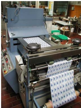
Abbildung 23: Spann-Trocken-Fixier-Anlage der Fa. Werner Mathis AG
