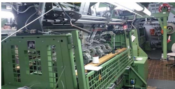
Abbildung 13: Rechts/Rechts-Doppelraschelmanchine RD 7 im Technikum des TITV Greiz
