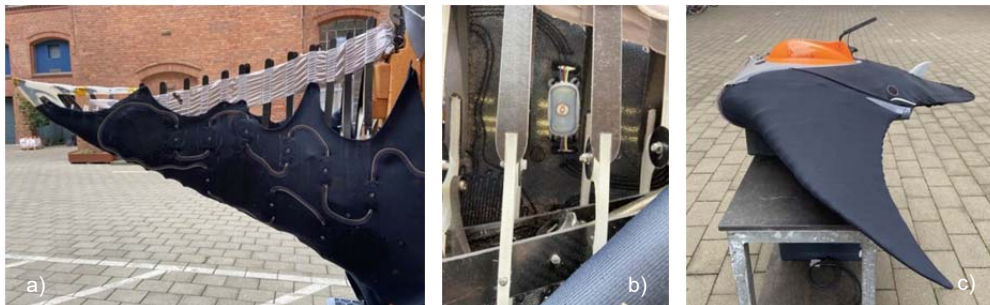
Abbildung 59: Finale Roboterhaut Manta (Quelle: Fa. EvoLogics, Berlin) a) Innenhaut; b) Modulrahmen mit Konnektorboards; c) Außenhaut
