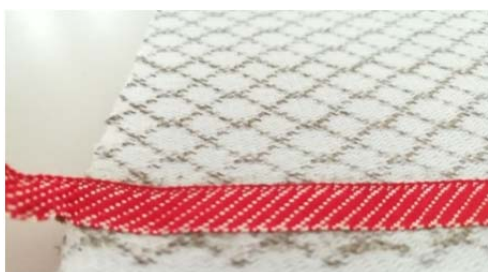
Abbildung 32: Leitfähig aufgeklebtes Kontaktierungsband auf der 3D-Kettengewirkestruktur
