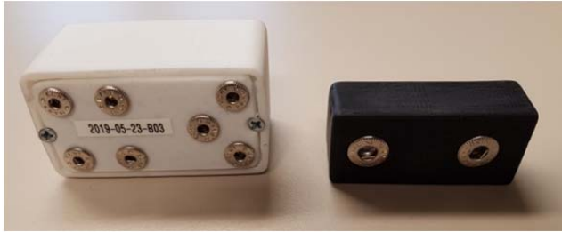
Abbildung 7: Elektronikmodul mit integrierten Druckknöpfen zur Kontaktierung auf Textilien
