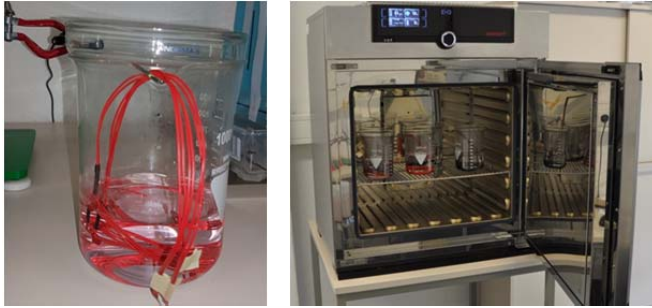
Abbildung 62: links: Becherglas mit einer isolierten, elektrischen Leiterprobe rechts: Wärmelagerung der Leiterproben im Memmert Universalofen UF110
