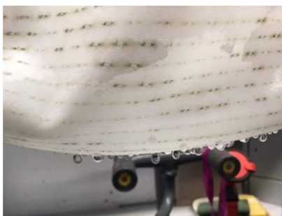
Abbildung 25: Wassertropfentest an laserperforierter Kaschierung auf 3D-Kettengewirke (Vorversuch zum Muldentest)
