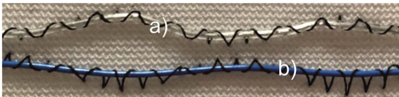
Abbildung 38: Verlegung unterschiedlicher Materialien bei gleichen Stichabstand und Mäanderauslenkung a) ELITEX® I; b) Drahtmaterial
