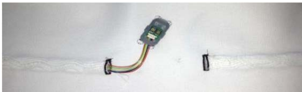
Abbildung 53: Verlegung der Leiterbahn im Winkel von ca. 90 ° zum Elektronikmodul
