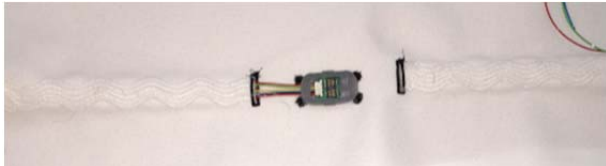
Abbildung 51: Gerade Zuführung der Leiterbahn zum Elektronikmodul
