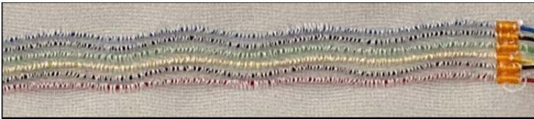
Abbildung 48: Gestickter Kabelbaum, erste Muster
