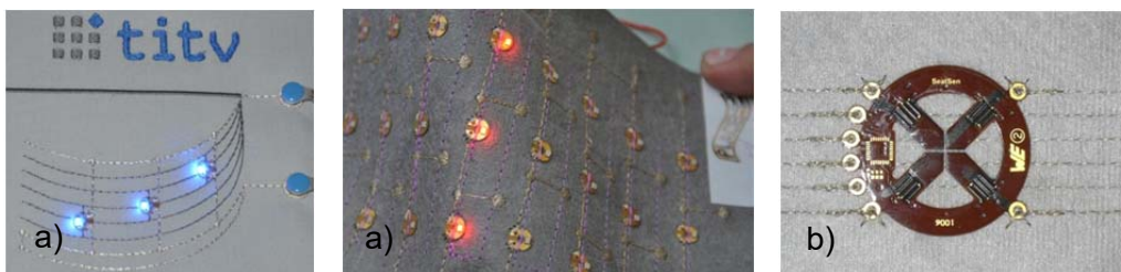
Abbildung 8: a) Angestickte FSD™ mit LED bestückt b) Angestickte Drucksensoren im Projekt „BMBF MST 16SV3457 SeatSen“
