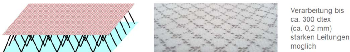
Abbildung 30: Vermaschte elektrische Leitung im 3D-Kettengewirke
