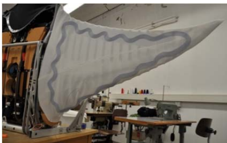
Abbildung 46: Auslegung der Antennenspule für das Georadar für erste Testzwecke bei Projektpartner Sensorik Bayern GmbH
