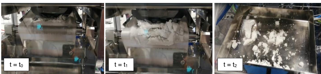
Abbildung 45: Zeitlicher Verlauf des Kuchenabwurfs. Zu Beginn befindet sich das Haufwerk waagrecht liegend auf dem Filtermedium. Nachfolgend einer Umlenkung wird das selbige durch einen Schaber vom Filtermedium entfernt und in einer Auffangschale gesammelt.
