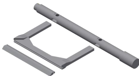
Abbildung 22: CAD-Zeichnung der Abnahmevorrichtung. Die modulare Baugruppe setzt sich aus einer Welle, einem Schaber und einer Lippe zusammen.
