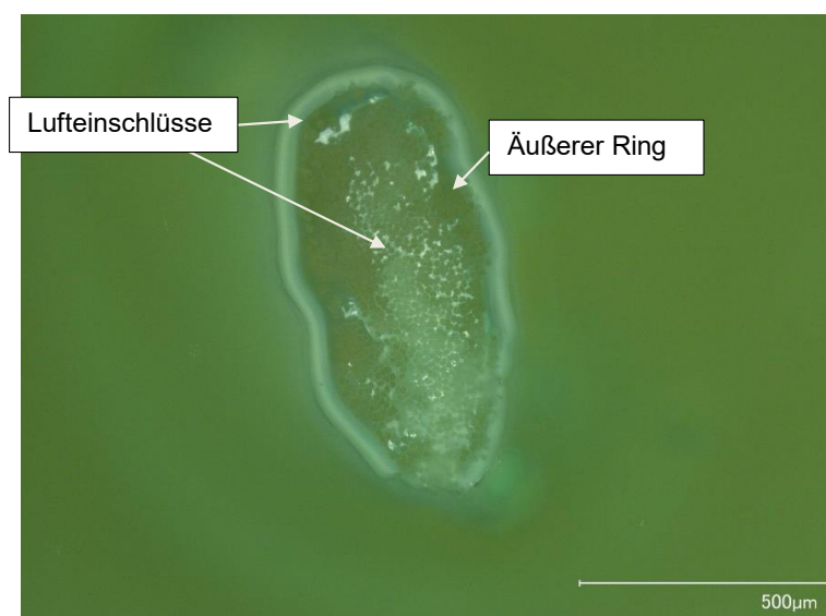
Abb. 22 Mikroskopische Aufnahme des Querschnitts der Filamentprobe P-80.
