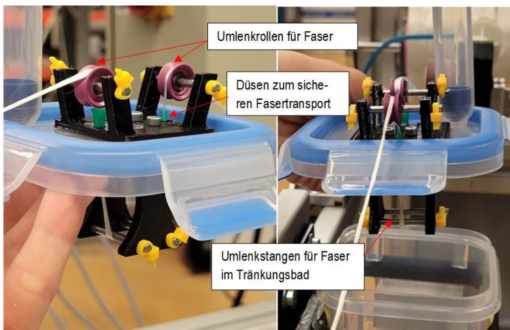
Abb. 16 Imprägnierungsbad für das Pultrusion von vorkonsolidiertem Filament.
