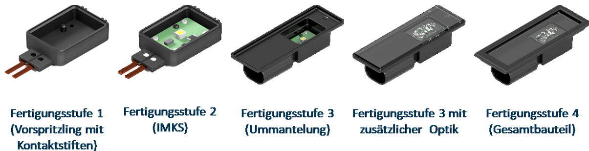
Abbildung 25: Die Kennzeichenrückleuchte in verschiedenen Fertigungsstufen
