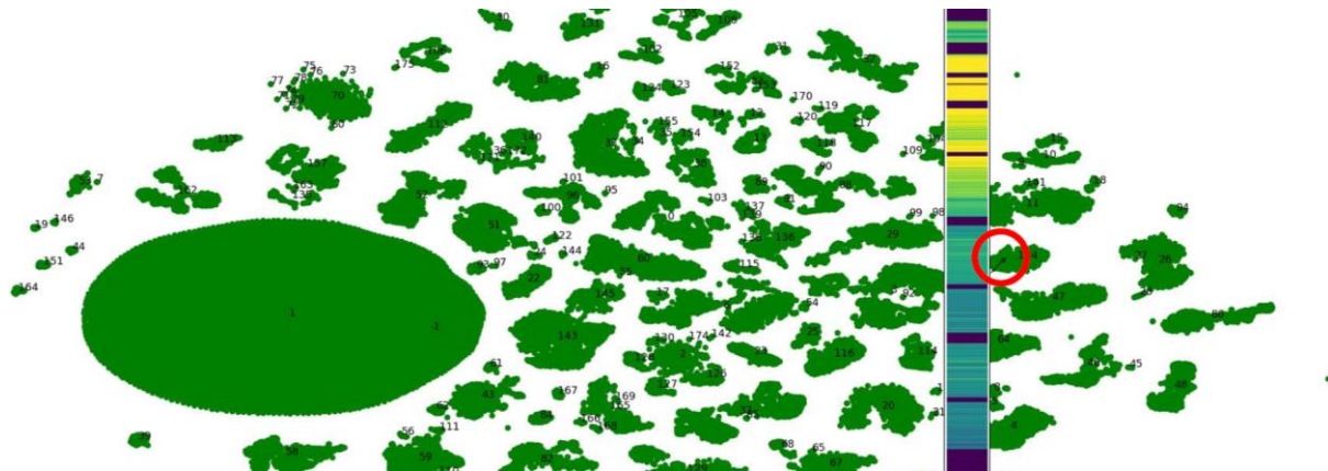
Abbildung 2-11: Zuordnung jedes SNR-Vektors aus FiN1 zu einem via DBSCAN ermittelten „Cluster“ (Quelle: DFKI)
