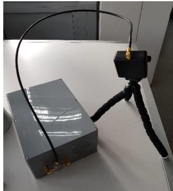
Abbildung 6: Vollständiges Lesegerät mit externer Antenne
