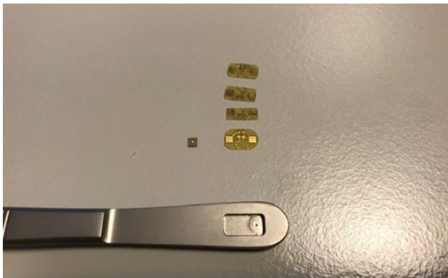
Abbildung 23: a) Pinzette mit großer Kavität & Dummies
