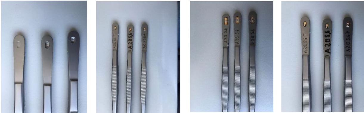
Abbildung 27: v.l.n.r. Pinzetten mit überarbeiteter Kavität, Pinzette mit kleinem Transponder-Antenne, mit mittlerer Transponder-Antenne und mit großer Transponder-Antenne
