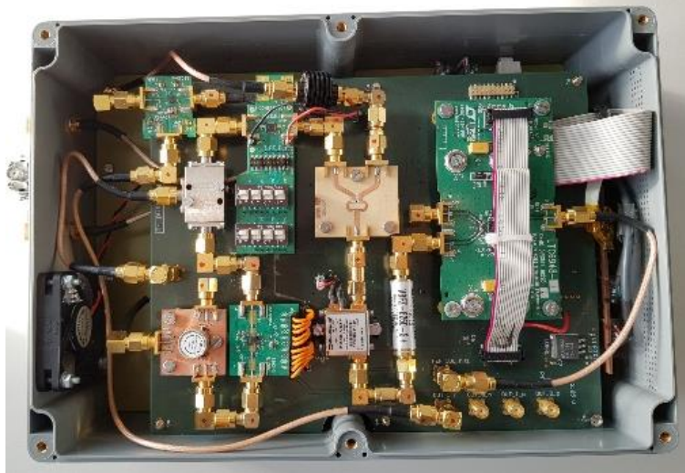
Abbildung 5: SHF Frontend des Lesegeräts für den Betrieb bei 5.8 GHz
