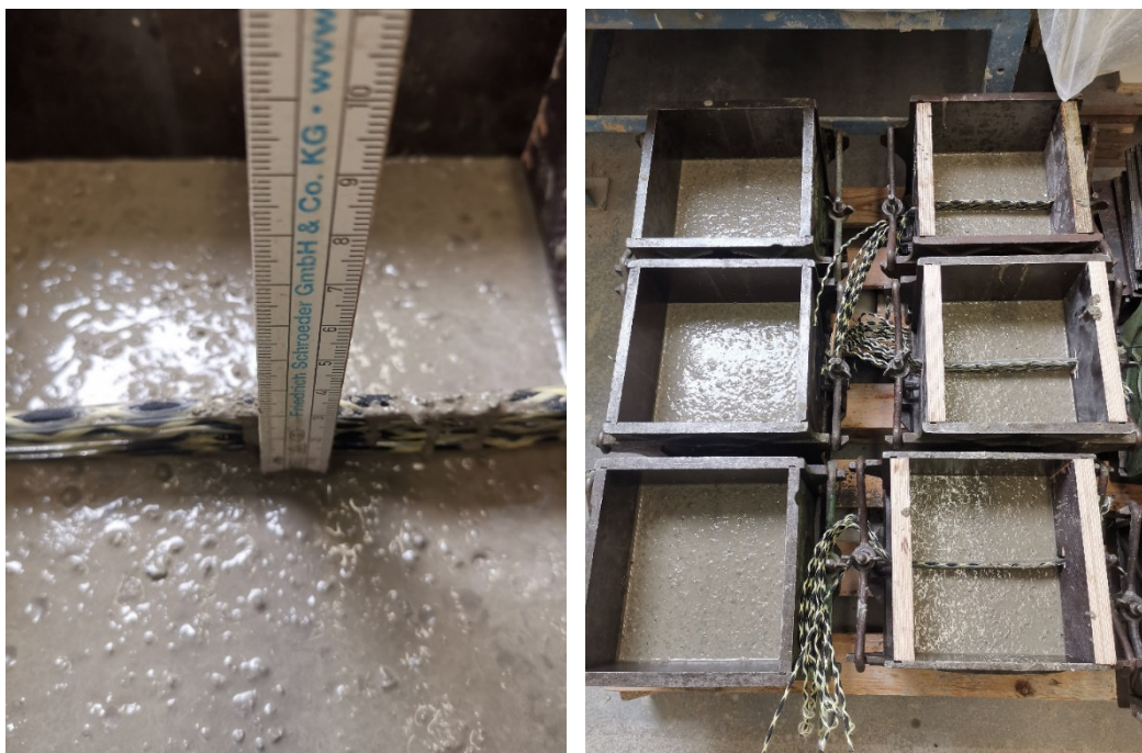
Bild 19: Erste Lage Beton (links) und WU-Prüfkörperschalungen mit und ohne eingebaute auxetische Fugenbänder (rechts)
