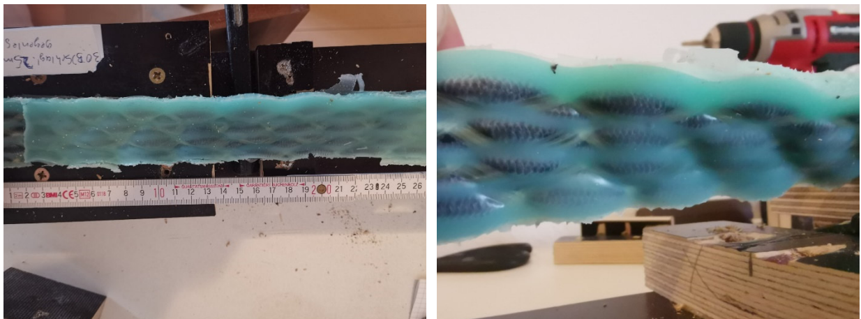
Bild 17: Versuchsdurchführung mit Kerndurchmesser 8 mm und gegenläufiger Anordnung der umhüllenden Faser: Volumenvergrößerung und Verformung Oberfläche (links) und im Detail (rechts)
