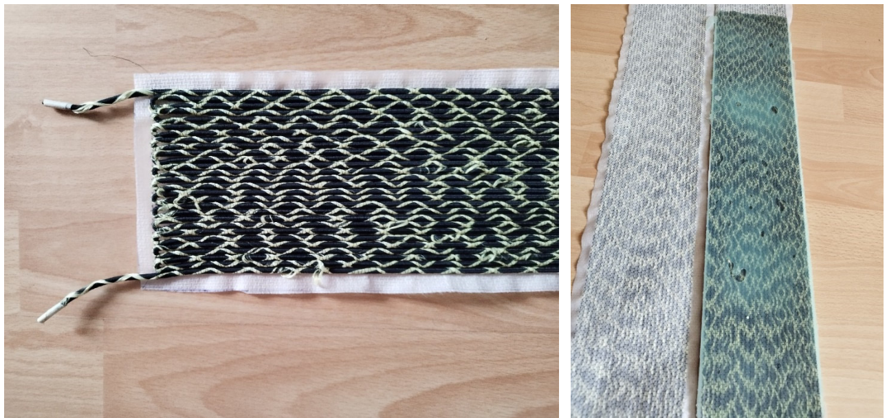
Bild 20: Flächenhaftes auxetisches Textil (links) und Vergleich vor und nach Einbettung in Silikonmatrix (rechts)
