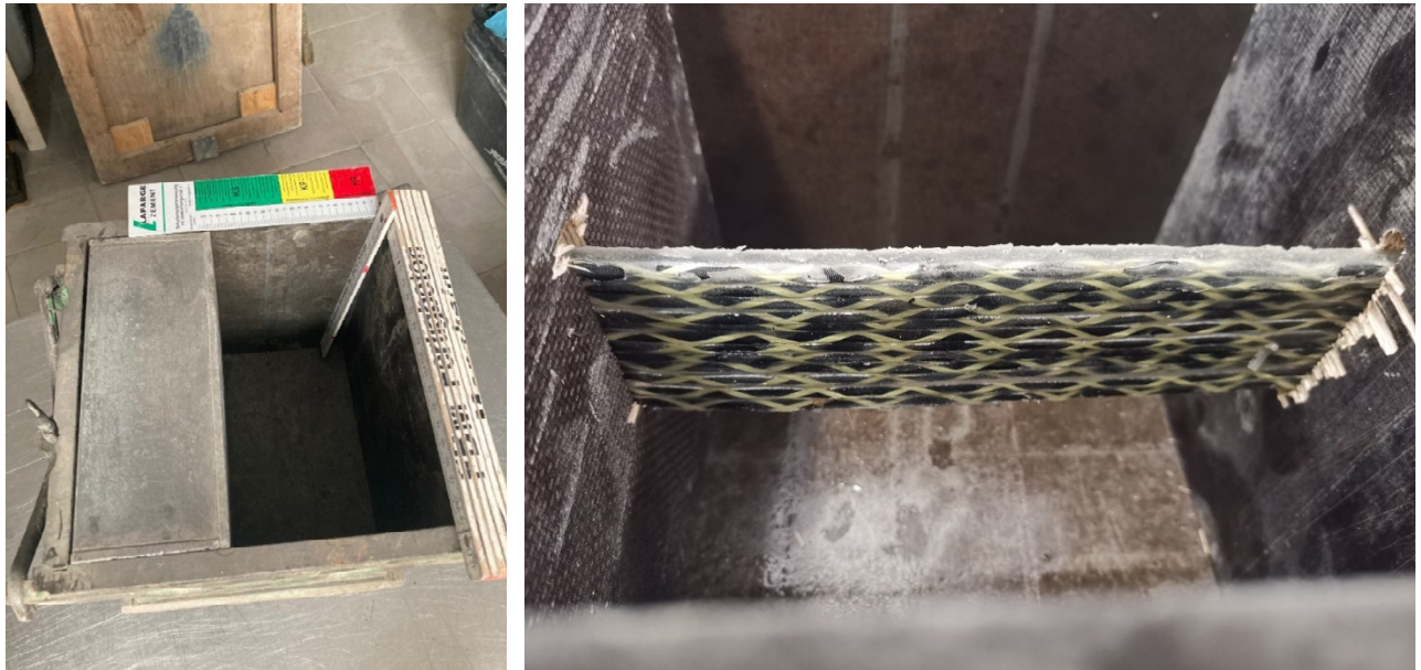
Bild 18: WU-Prüfkörperschalungen (links) und mit eingebautem auxetischem Fugenband (rechts)
