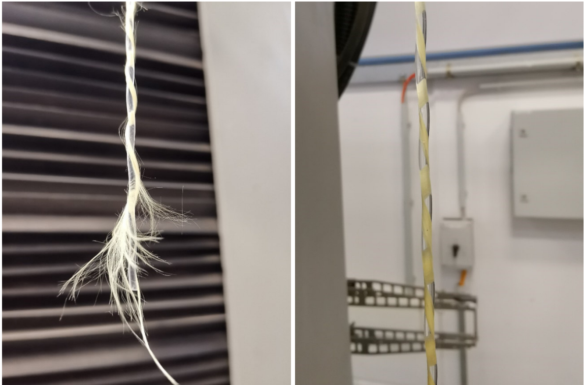
Bild 10: Typisches Versagensbild (links) und Einschnüren des elastischen Kerns sowie Ausbildung des auxetischen Effekts (rechts) bei Nutzung von Material 1
