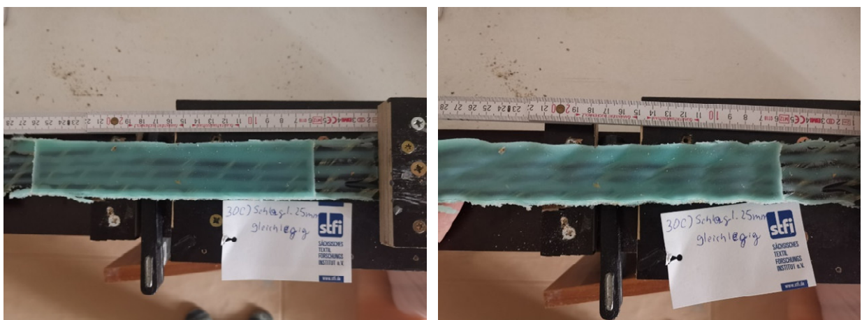
Bild 16: Versuchsdurchführung mit Kerndurchmesser 8 mm: vor Zugversuch (links) und Volumenvergrößerung und Verformung Oberfläche (rechts)
