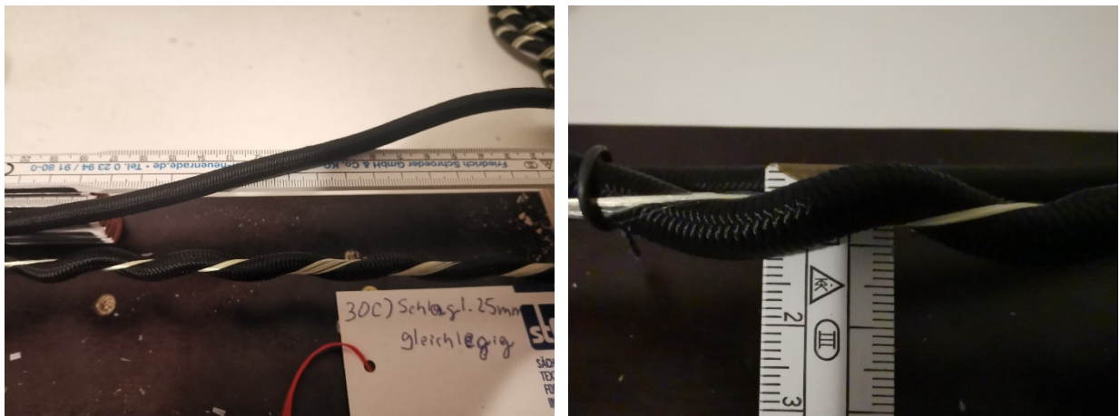
Bild 13: Versuchsdurchführung mit Kerndurchmesser 8 mm: Volumenvergrößerung (links) und im Detail (rechts)
