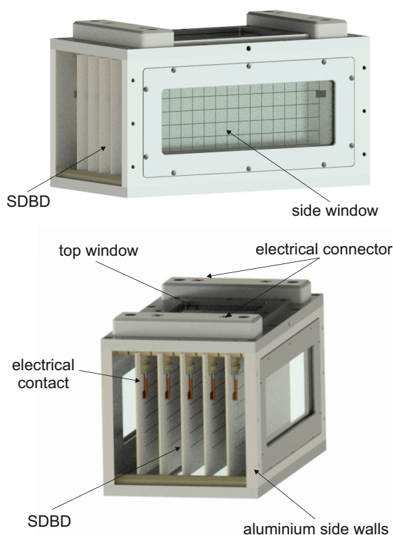
Abbildung 1.1: Zeichnung der im Projekt entwickelten Plasmakammer. [1]
