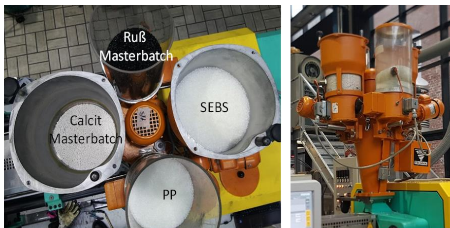
Abbildung 44. Dosieraggregat für die einzelnen Materialkomponenten (ohne direkte Pulverzufuhr)
