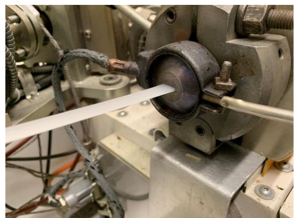
Abbildung 63. Herstellung von TPE-Blends auf einem Einschneckenextruder im Labormaßstab
