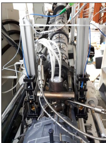
Abbildung 40. 3-D Druckteil zur Aufnahme der Quarzglasfenster
