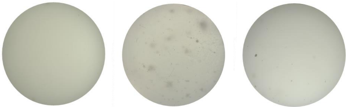
Abbildung 46. Visuelle Probenanalyse der Calcit-Agglomerate, links: Vorcompoundiertes Material; Mitte: Direktverarbeitung mit Standardschnecke; rechts: Direktverarbeitung mit einer neuen Geometrie
