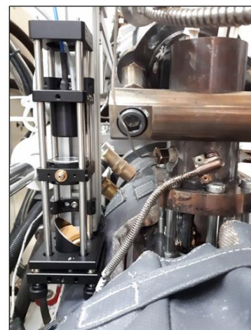
Abbildung 40. 3-D Druckteil zur Aufnahme der Quarzglasfenster
