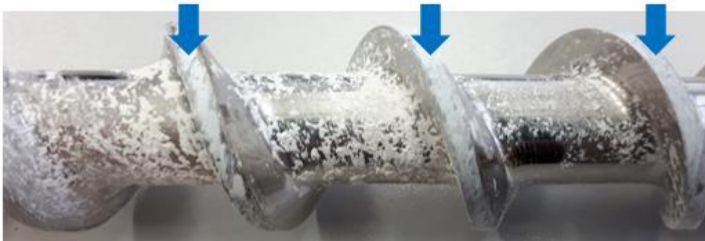
Abbildung 15. Ablagerungen von Calcit auf dem Schneckensteck in der Einzugszone
