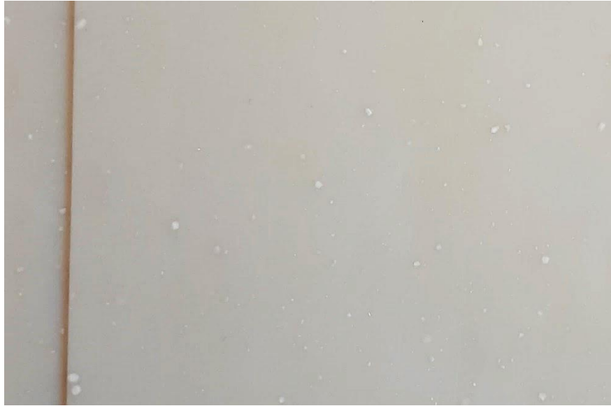
Abbildung 14. Calcit Cluster an der Bauteiloberfläche
