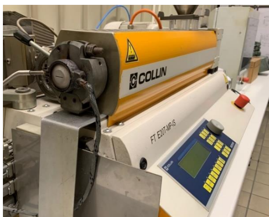
Abbildung 63. Herstellung von TPE-Blends auf einem Einschneckenextruder im Labormaßstab
