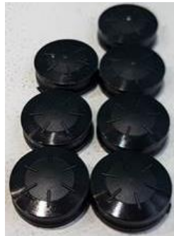
Abbildung 18. Technologieträger Spritzenstopfen (Direkt hergestellte Probespritzenstopfen)
