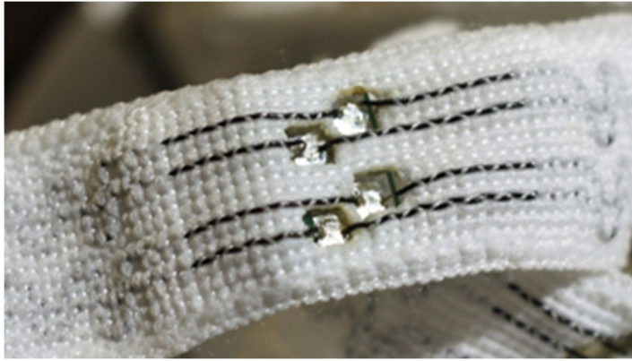
Abbildung 19: Kontaktierung einer Leiterplatte mit einem textilen Band mittels Thermodenlötten
