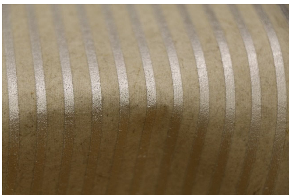
Abbildung 48: Gedruckte Leiterbahnen auf einem Vliestapete
