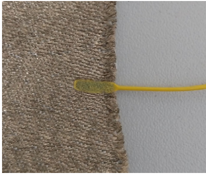
Abbildung 27: Kontaktierung eines Mikrokabels mit einem leitfähigen Textil mittels Ultraschall-Schweißen
