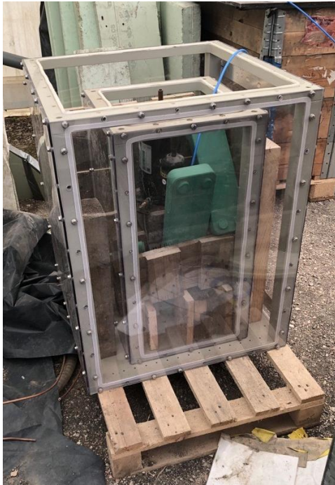
Abbildung 34: Prüfaufbau Level 3 (Gehäuse im Gehäuse), mit dem gleichen freien Innenvolumen wie der Aufbau des Level 2,
