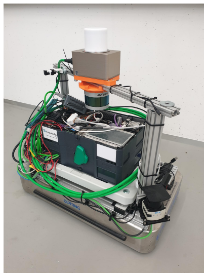
Abbildung 10: Mockup Sensoraufbau auf fahrerlosem Transportsystem KATE
