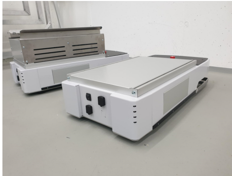
Abbildung 21: robotische Drehschemelfahrplattformen der Demoszenarien. Links mit integrierten Kurzhubtisch, rechts Standardausführung
