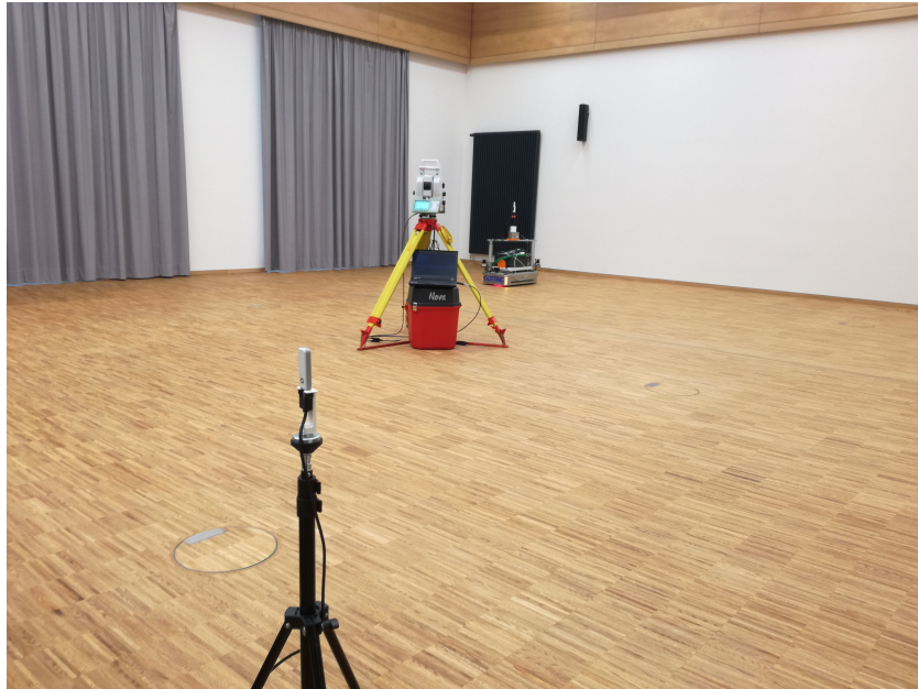
Abbildung 17: Messaufbau zur Sensorqualitätsbewertung, RTLSAnchor auf schwarzem Stativ, Tachymeter-Referenzmessstation auf gelben Stativ, Fahrplattform mit vorbereiteter Sensortechnik
