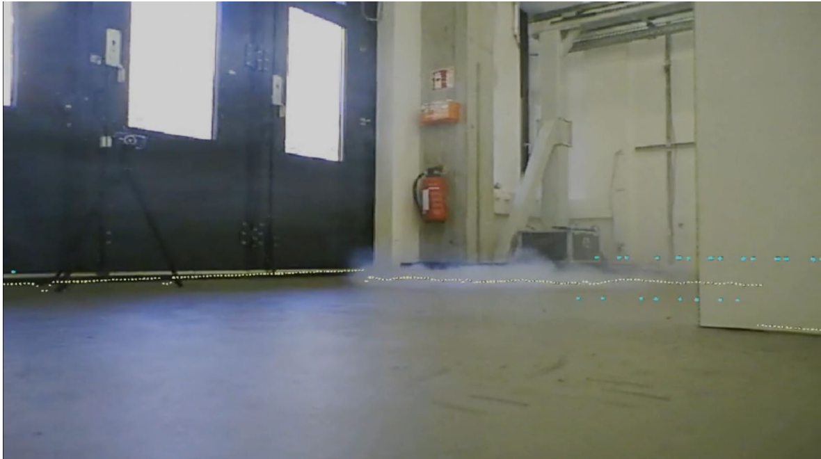
Abbildung 25: durch Nebel teilweise blockierte LiDAR-Daten(weiß) und RaDAR-Daten(cyan) eingeblendet in aktuelle Kamerasicht der Versuchsplattform
