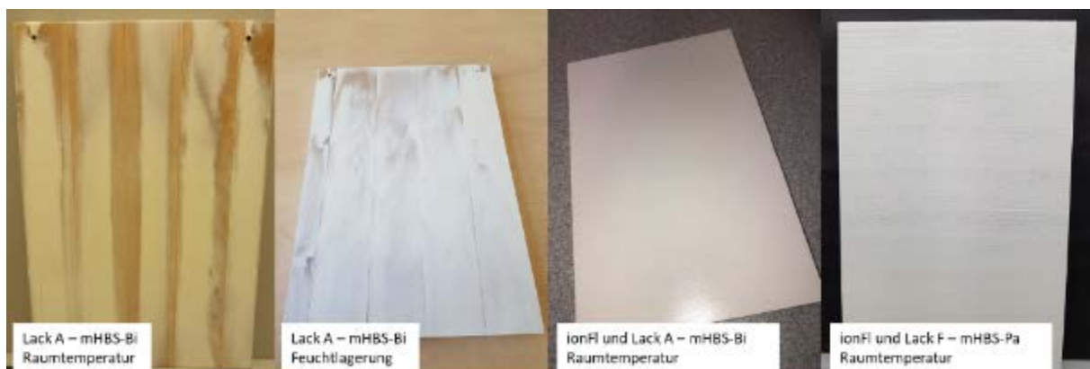
Abbildung 51: Pulverlackauftrag ohne ionFI nach den jeweiligen Konditionierungen mit Lack A auf mHBS (Bi) und mit Lack F auf mHBS (Po, rechts)
