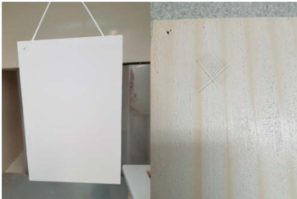
Abbildung 50: Pulverlackauftrag Lack E (Leitprimer und Decklack) auf mHBS (Po) mit ca. 50-60 \mu\text{m} nach Leitprimer (links) und nach Prüfung der Haftfestigkeit GT=0 (rechts)
