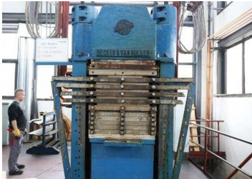
Abbildung 61: Mehretagenheizpresse mit Pressgut
