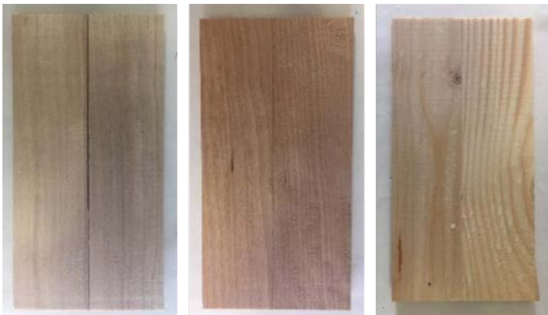
Abbildung 12: Probekörper Pappel, Birke und Fichte nach der Formatierung und Schmalflächenverklebung
