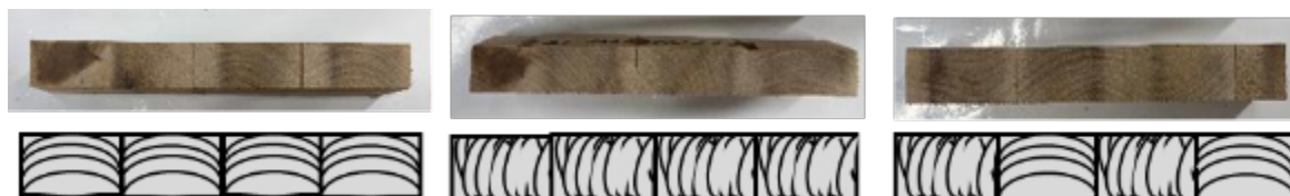
Abbildung 29: Jahrringordnung in der verklebten Paneele (verdichtet) und schematisch (links-tangential tan; mittig: radial-rad, rechts: radial-tangential-rad/tan)
