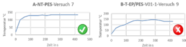
Abbildung 5: Ofenkurven geeigneter Pulverlack (links), nicht geeigneter Pulverlack (mittig) und Durchlaufkanal ContiLine LAB (rechts)
