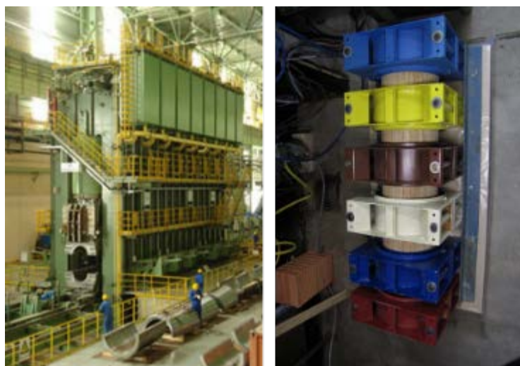
Abbildung 66: Produktionsanlage für eine großtechnische Herstellung von Formkörpern aus Metall (links; Foto Thyssen/Krupp); manuelle 3D-Formkörpervorrichtung mit Holzwerkstück (rechts)
