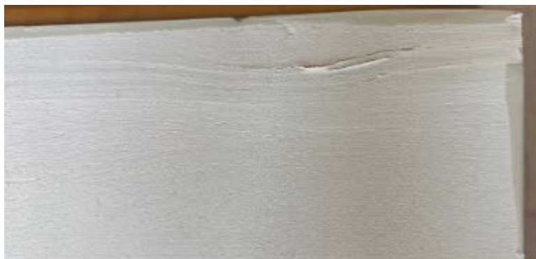
Abbildung 74: Pulverlack F-NTP-EP/PES mit F-NT-PES auf mHBS Bi nach künstlicher Bewitterung, Lackrisse im Kantenbereich
