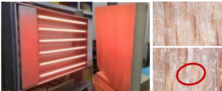
Abbildung 32: Paneele (links) während des post-treatments zur Veränderung der Zellstruktur und der chemischen Eigenschaften (Hygrophobierungsfähigkeit), sowie zum Abbau der inneren Spannungen, Zellstruktur Pappel (rechts) mit gelösten Zellfibrillen (rechts unten)
