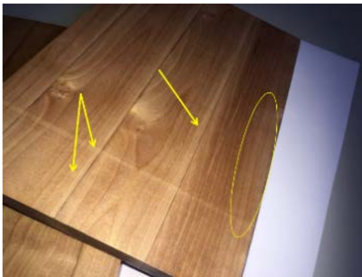
Abbildung 72: Pulverlack G-UV-PES auf mHBS Bi, markiert (gelb) sind einige Fehlstellen, die nur unzureichend bzw. nicht mit dem Pulverlack beschichtet waren
