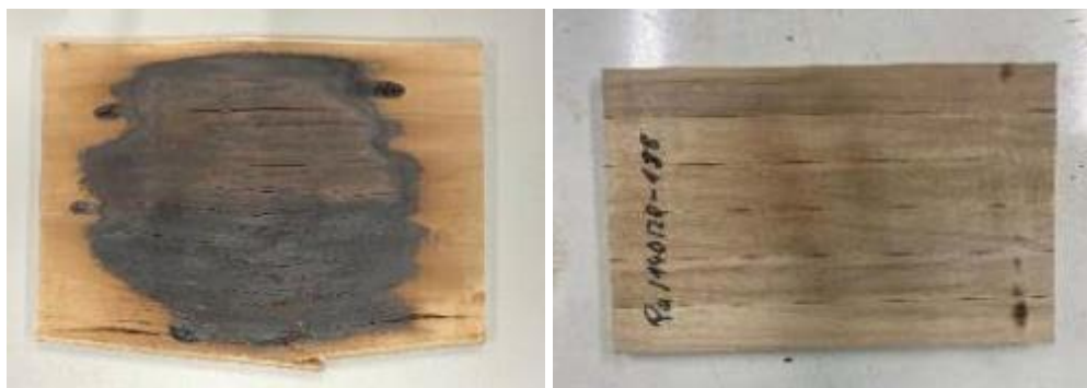
Abbildung 33: Paneel mit 180°C Prozesstemperatur durch Kontakt (links) und Strahlung (rechts) erwärmt
