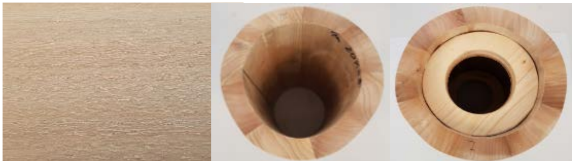
Abbildung 67: Oberfläche (links) der zu beschichtenden Formkörper (Po), Deformation durch Verformung der Paneelenstruktur (mittig), Formkörper mit stabilisierendem Distanzring (rechts)
