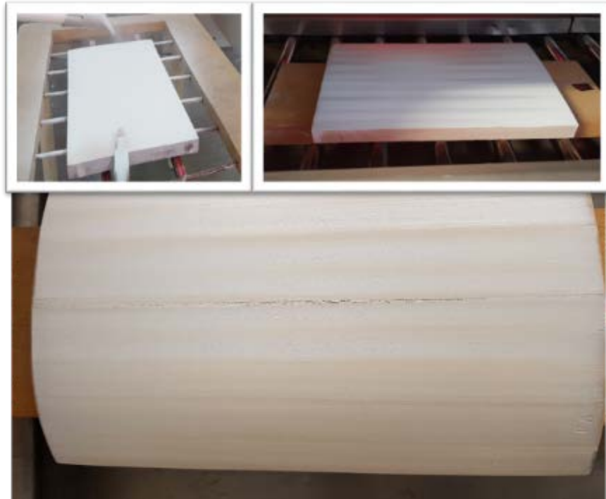
Abbildung 49: Pulverlackauftrag im Gegenfeld (links oben), Aufschmelzen im IR-Kanal (rechts oben) und aufgeschmolzener Pulverprimer (Lack E) auf mHBS Po mit Deformation und Rissen an Klebestelle
