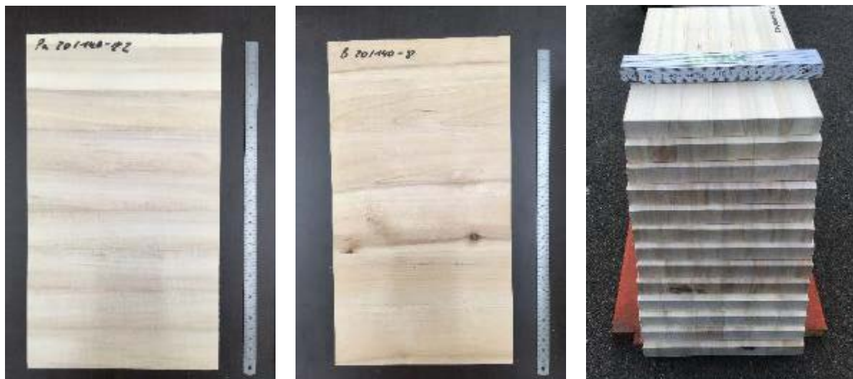
Abbildung 23: Platten-Probekörper 300 \times 200 \times 20 \text{ mm}^3 aus Pappel, Birke (quergerichtet), 1K PUR-verklebt mit 20 % Verdichtung bei 140^\circ\text{C} und längsgerichtet (rechts)
