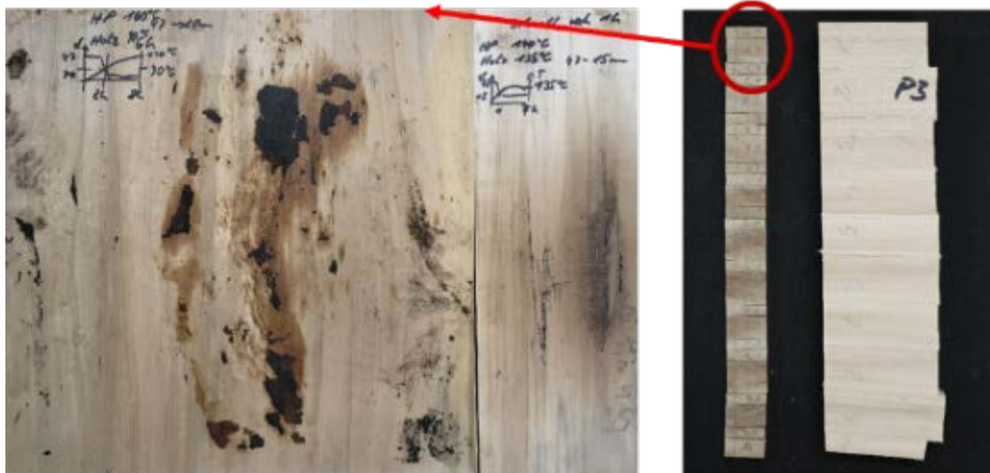
Abbildung 22: Probekörper aus Pappel vor (links) und nach der Plattenherstellung (rechts) mit unterschiedlicher Verdichtung, Kennzeichnung der Einzellamellen jeder Platte zur Bestimmung von Kennwerten an Besäumabschnitten (ca. 100 mm)
