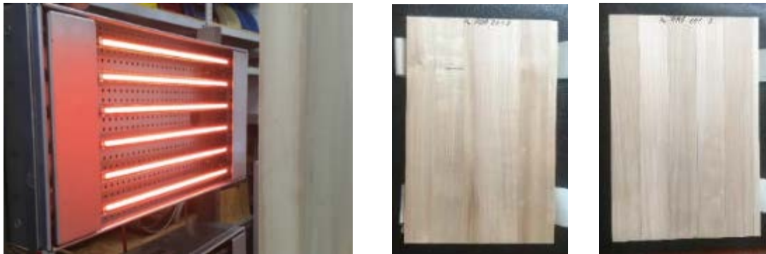
Abbildung 26: IR-Carbon-Strahler während des Temperns einer Pappelholzplatte bei 160°C Oberflächentemperatur (links) und Plattenproben mit 1K PUR- und PF Res-Verklebung nach dem Tempern (mittig, rechts)
