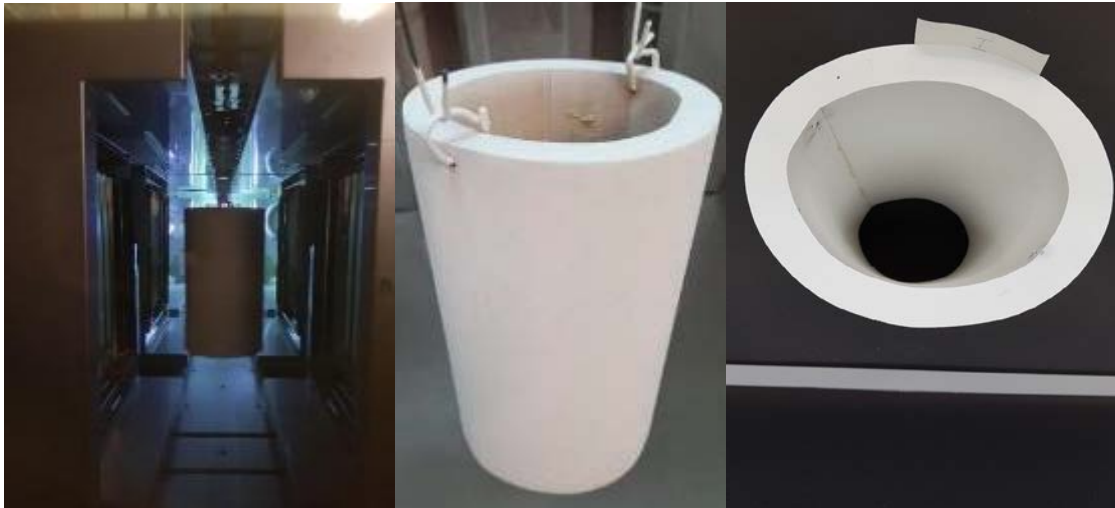
Abbildung 68: Rotierende Durchfahrt des Formkörpers durch den Durchlaufofen (links), Pulverlackapplikation auf den Formkörper (außen-mittig, innen – rechts)
