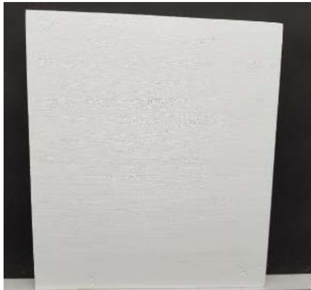
Abbildung 57: Pigmentierter UV-Lack G, einschichtige Applikation, Vernetzung UV-LED, GT = 1
