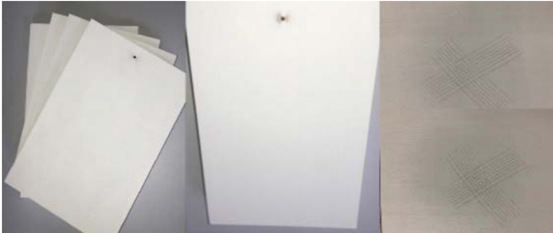
Abbildung 73: Pulverlack F-NTP-EP/PES mit F-NT-PES auf mHBS Bi (links, mittig), GT trocken = 0 (oben rechts) und GT nass = 1 (unten rechts)
