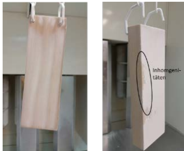
Abbildung 19: Vergleich der Pulverlackhaftung auf Referenz Accoya ohne ionFI (links) und mit ionFI (rechts)
