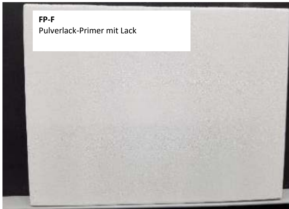
Abbildung 52: Pulverlack F auf Pulverlack-Primer auf mHBS (Po); (Schritt 1)
