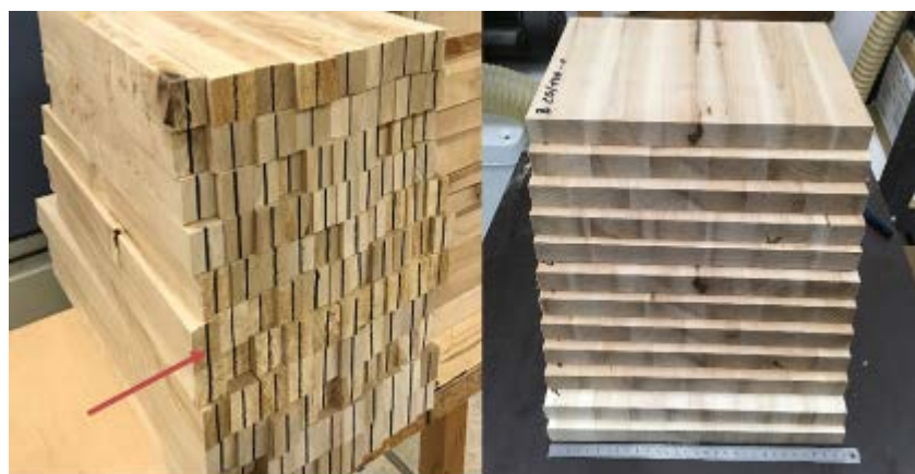
Abbildung 64: Kennzeichnung der Verdichtungsrichtung (Pfeil) der Einzellamellen (links), formatierte verdichtete Birkenholzpaneele (rechts)
