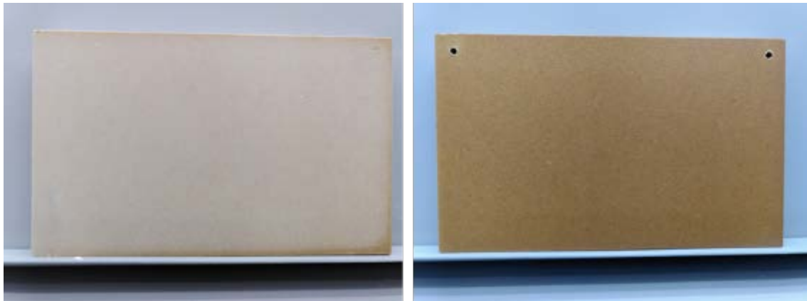
Abbildung 10: Referenzsubstrate pulverbeschichtet (Beispiel B-UV clear01-PES/AY auf MDF-Ref, links - nicht aufgeschmolzen (90°C), rechts - aufgeschmolzen (130°C))
