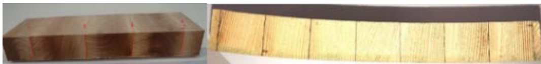
Abbildung 43: Paneele verklebt zu mHBS tangential/radial (links) mit eher geringerer Deformation und tangentialer Verlauf der Jahresringe (rechts) mit stärkerer Verformung
