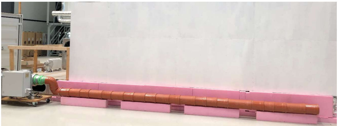
Abbildung 6: Anschluss der Zwischenbodenheizung auf der östlichen Seite des Mock-Up.
