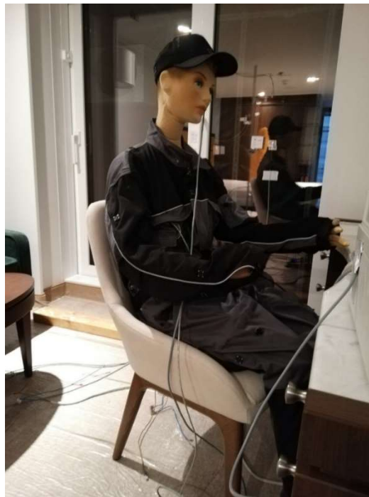
Abbildung 7: DressMAN 2.0 zur Bewertung der thermischen Behaglichkeit im »Büro-Bereich« der betrachteten Kabine.
