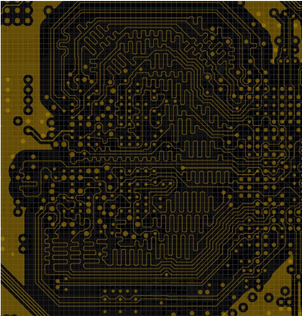
Abbildung 22: D(C) Layout, Signallage SIG3, Anbindung von LPDDR4
