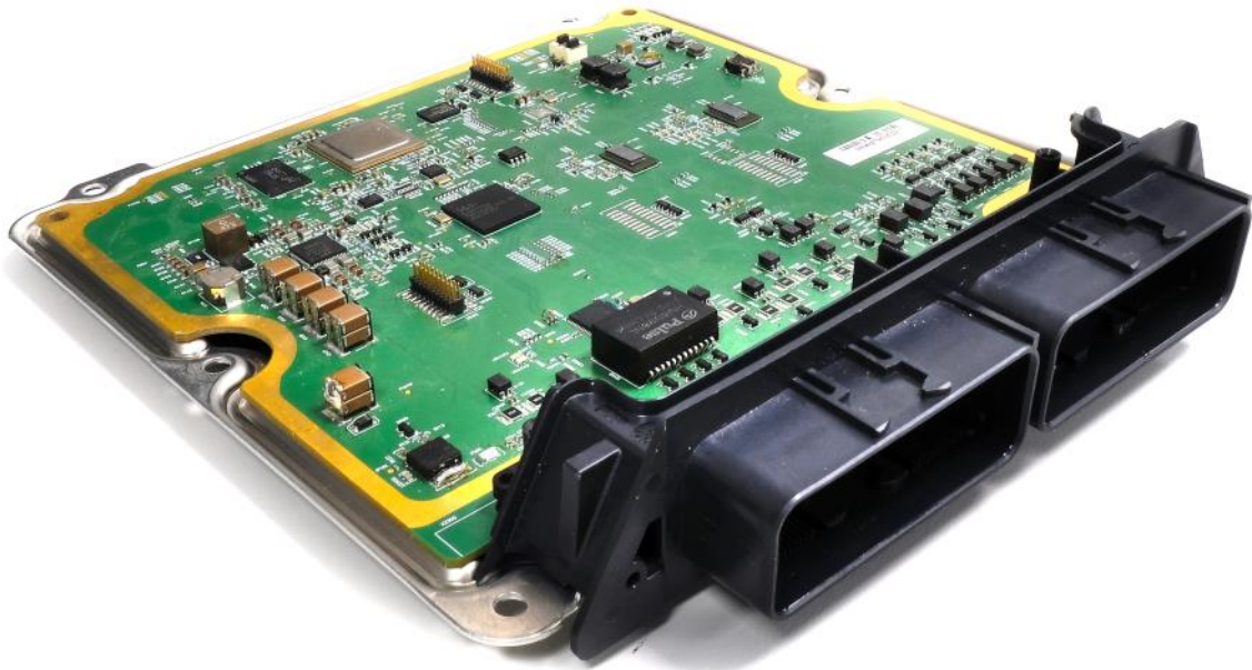
Abbildung 25: D(C) mit bestücktem Gerätestecker und Gehäuse-Unterseite
