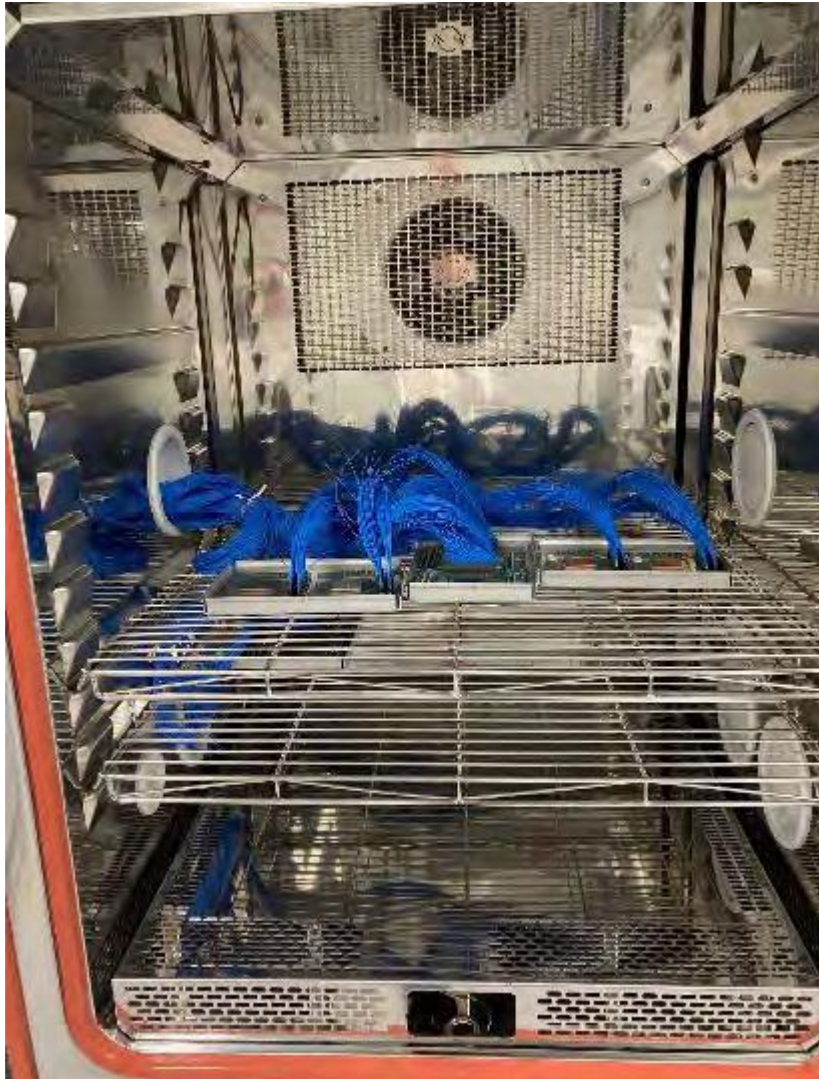
Abbildung 63: Mehrere D(TR) in einer Temperaturkammer für einen passive temperature cycling Test
