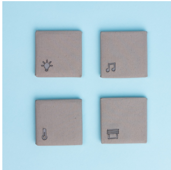
Abbildung 15: funktionsfähige Patches zur Steuerung von Licht, Klima, Rollo und Sound
