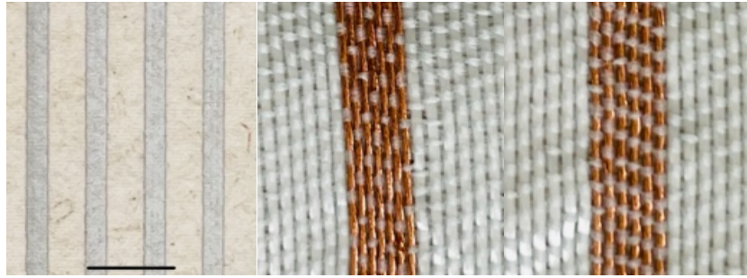
Abbildung 23: Muster für die Funktionsschicht der textilen Infrastruktur: Siebdruck auf Vlies (IFAM) und Gewebe mit leitendem Garn (DITF)
