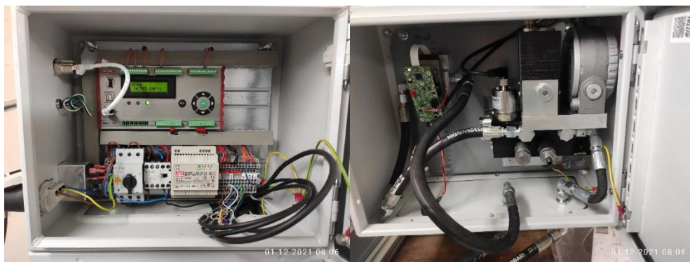
Abbildung 3, Sensorbox zum Anschluss der Sensoren an Anlagen und Kommunikation mit dem Lube.Life System; links: HYDAC Datenerfassung; rechts: Sensoranbindung
