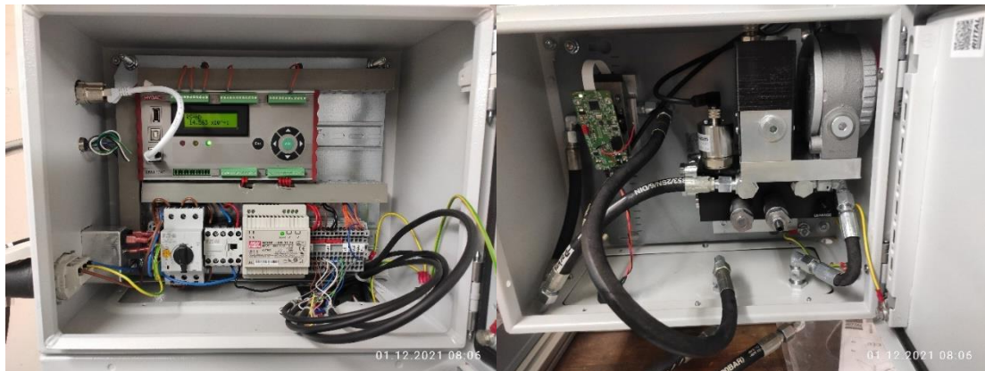
Abbildung 27, Sensorsystem; links: Datenerfassung mit Spannungsversorgung; rechts: Hydraulikkreis mit eingebundenen Sensoren
