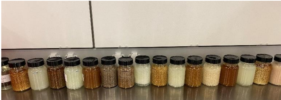
Abbildung 39, Mit Fluid und Ionenaustauscherharz gefüllte Probengläser
