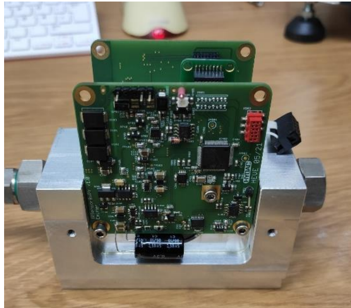
Abbildung 17, Platine und Fluidblock des 8-fach IR Sensors
