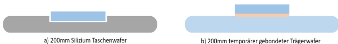
Abbildung 3: Gegenüberstellung der Trägertechnologien für die Prozessierung von 3'' Wafermaterialien
