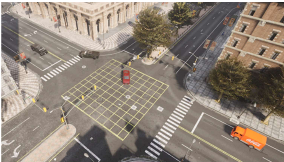
Abbildung 19: Kreuzungsszenario im Simulationstool CARLA mit Fahrzeugen gesteuert vom ika Agentenmodell.
