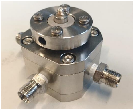
Abb. 21 Fertiggestellte und montierte an das Stoffsystem von WACKER angepasste Messzelle V3.1
