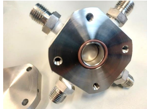
Abb. 21 Fertiggestellte und montierte an das Stoffsystem von WACKER angepasste Messzelle V3.1
