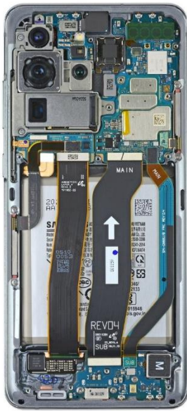
Abbildung 13: Samsung Galaxy S20 Ultra mit rechteckiger Hauptplatine (Fotoquelle: iFixit 1 )
