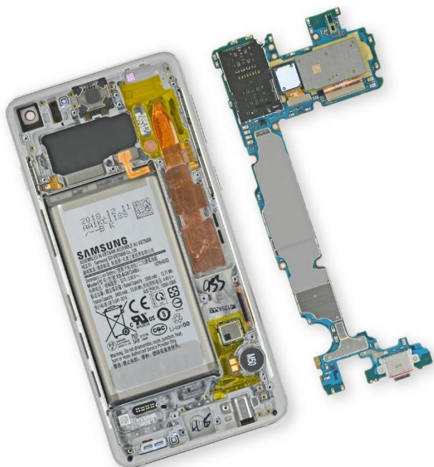
Abbildung 12: Samsung Galaxy S10 mit L-förmiger Hauptplatine (Fotoquelle: iFixit 1 )
