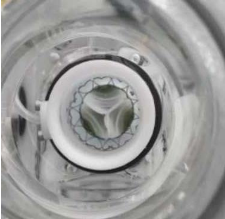
Abbildung 16: Unphysiologische Überlappung der Kommissuren bei Aortenklappenprothesen aus elektrogesponnen Polymervliesen nach 15 min im Vivitro-Klappentester
