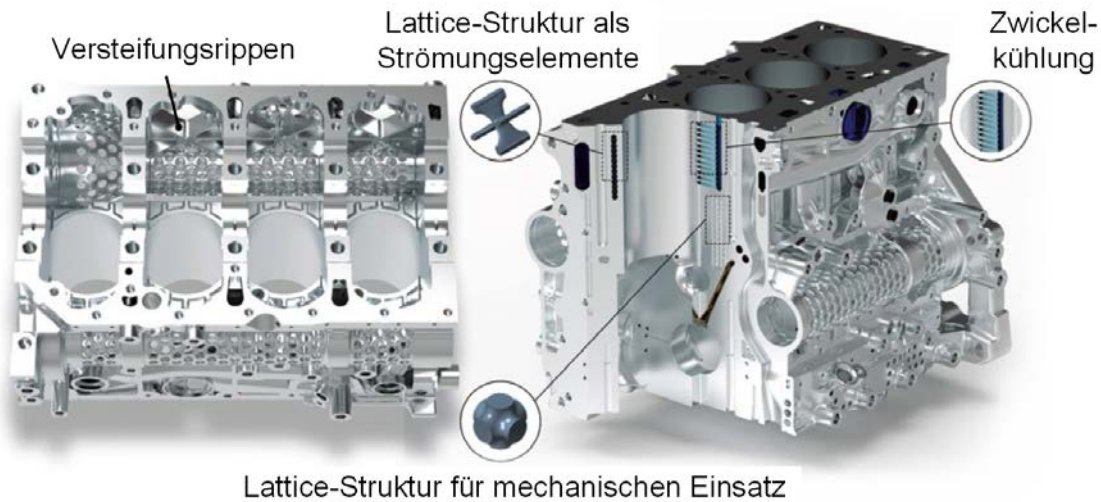
Abbildung 6.37 Konzept des additiv gefertigten Kurbelgehäuses im LeiMot-Forschungsprojekt [LIN 20]
