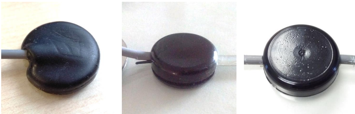
Abbildung 1: Spritzgegossene Kontaktkappen der ersten (Variante A1; links), zweiten (Variante A2; Mitte) und dritten (Variante A3; rechts) Generation.
