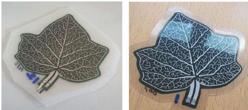
Abbildung 28: Verkapseltes OPV-Testmodule laminiert zwischen zwei Lagen Gewächshausfolie GH4 mittels EVA2-Schmelzklebstoff zur Untersuchung der chemischen Kompatibilität von OPV und EVA2 (links) und OPV-Referenzmodule verpackt in Barrierefolie (rechts).
