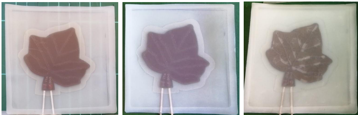
Abbildung 33: Änderungen der Lichtdurchlässigkeit eines zwischen Gewächshausfolie GH4 laminierten Moduls vor dem Feuchte-Wärme-Test (links), nach 5 Tagen Lagerung bei 65°C und 85% relativer Feuchte (Mitte) und nach weiteren 25 Tagen bei 85°C und 85% relativer Feuchte (rechts).
