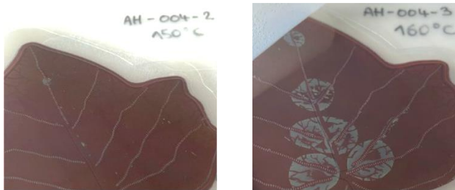
Abbildung 14: Blasenbildung (Delamination) in OPV-Modulen bei zu hohen Laminationstemperaturen von 150°C (links) und 160°C (rechts).
