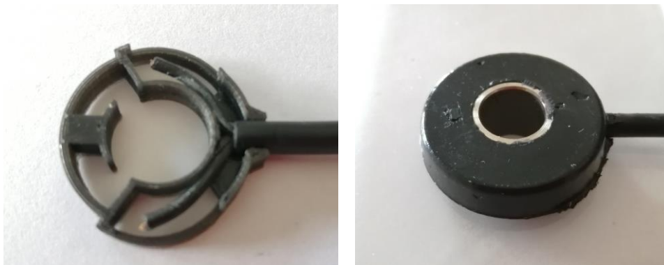
Abbildung 4: Herstellung der Kontaktkappe A5. Kabelhalter samt Anschlusskabel (links) wird komplett umspritzt um die fertige Kappe (rechts) zu erhalten. Die rechte Seite vom Kabelhalter hält das zweiadrigte Anschlusskabel mittels Zähnnchen fest; in diesem besonderen Kappendesign umklammert der Kabelhalter zusätzlich eine Metallhülse für eine extra Verankerung.
