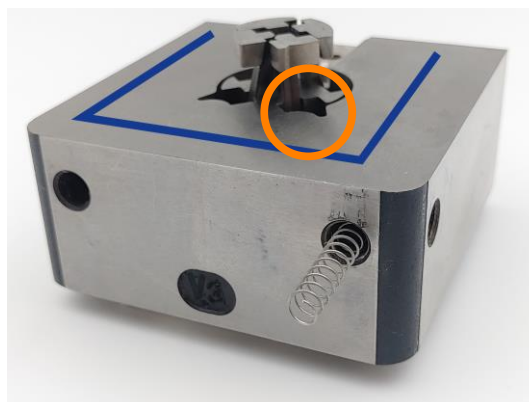
Abbildung 52: Formeinsatz zur Herstellung von Rohrclips. Der Verlauf des Temperierkanals ist mit einer blauen Linie dargestellt. Der Formteilmereich der Masseansammlung (orange markiert) ist dem Temperierkanal zugewandt. Im Bild ist die Feder eines Teilkanals erkennbar.
