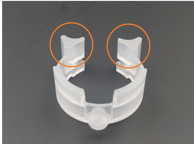
Abbildung 50: Kunststoffclip-Formteil zur praktischen Untersuchung des Einflusses von statischen Mischelementen zur Optimierung von Hotspots, welche durch Materialansammlungen (orange markiert) verursacht werden.
