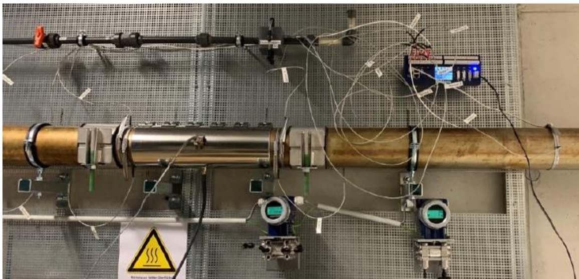
Abbildung 6: Umgebaute Rohrstrecke mit Messingrohr, Thermoelementen, digitalen Differenzdruckmesssystemen, Datenlogger und geregelter Heizquelle.
