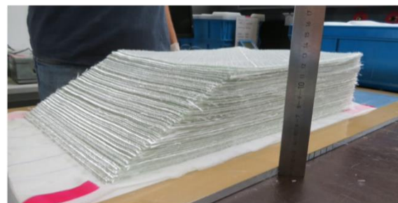
Abbildung 16: Konzept zur Integration von Verfahrenskontrollproben (links); umgesetzter Stufenkeil am Glasfaserpreform (rechts)
