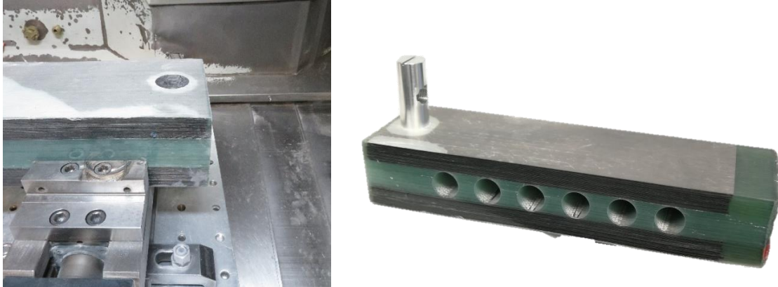
Abbildung 31: Aufspannung und mechanische Bearbeitung des FML-Demonstrators (links) und gefertigte Längs- und Querboreungen (rechts)
