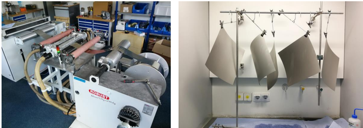
Abbildung 28: Sandstrahlen (links) und Trocknung der Sol-Gel-behandelten Metallfolien (rechts) für den 3D-Demonstrator
