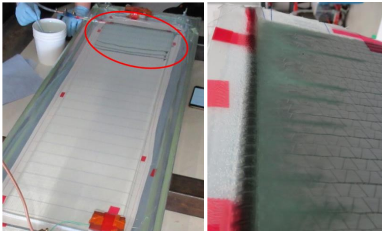
Abbildung 8: Abgebrochener erster Infusionsversuch mit Nanodispersion
