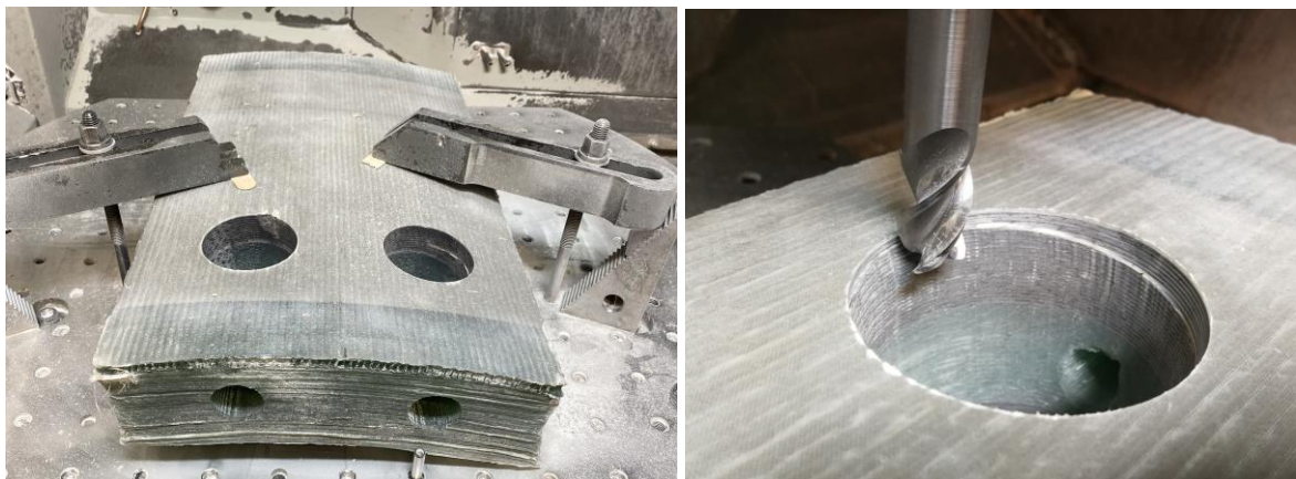
Abbildung 34: Zerspanung wasserstrahlgeschnittener Bohrung auf Endkontur
