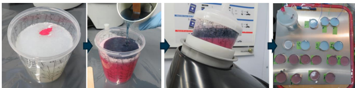
Abbildung 15: Untersuchung zur Verarbeitung nanomodifizierter Harzsysteme mittels Speedmixer: Bestimmung von Mischdauer und -güte sowie Reaktivität
