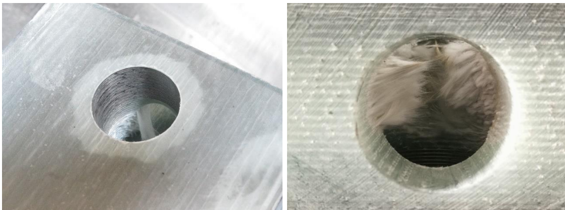
Abbildung 32: Schnittbild der 40 mm-FML-Querbohrung (links) sowie durch das Bohren ausgerissene Glasfaserrovings einer Längsbohrung (rechts)
