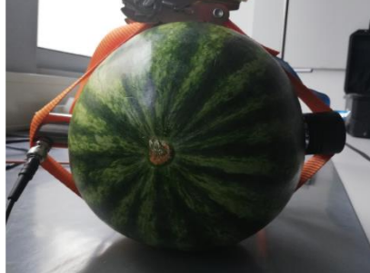
Abbildung 7. Beispiel für den Aufbau der Ultraschalluntersuchung mit Wassermelonen
