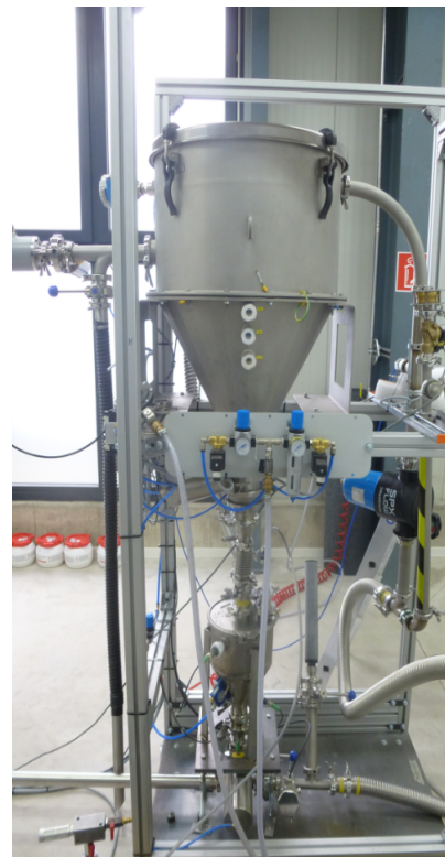
Abbildung HAP2.1.3 R&I-Fließschema (links) und realer Versuchsaufbau zur automatisierten Pulverförderung mit zusätzlichen Druckluft-Turbinenvibrator (rechts)
