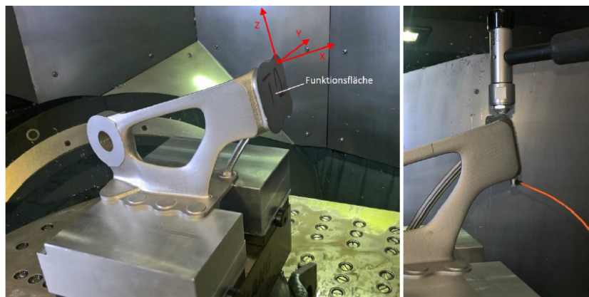
Abbildung 4.3.1: Experimentelles Setup für die Messung mit der Impulshammer Methode
