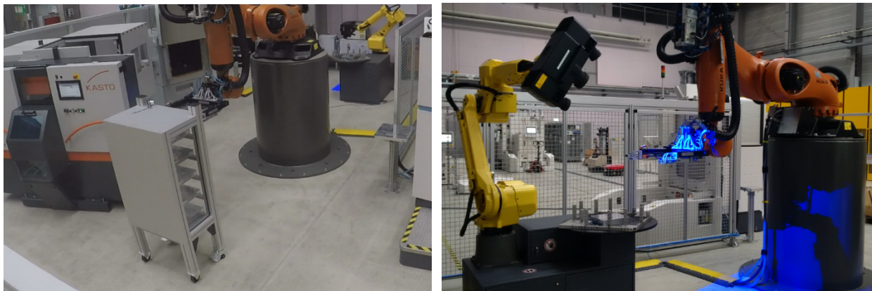
Abbildung 2.3.1: Verknüpfung der Einzelprozesse in einer Zelle und Funktionstest / rechts 3D Vermessung
