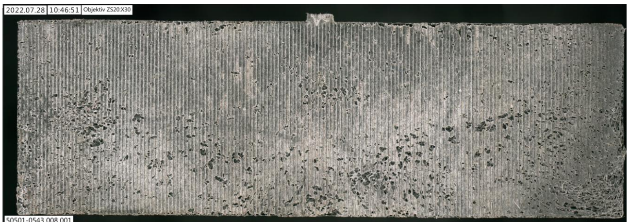
Bild 7: Beispiel Mikroskopieaufnahme Bruchbild, Kunststoffseite
