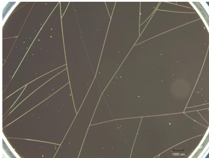
Abbildung 9: Exemplarisches Abbild eines gerissenen Multischichtsystems.
