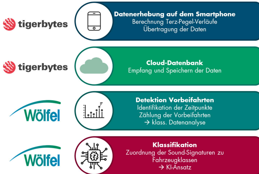
Abbildung 1: Prozessschritte für eine akustische Verkehrsüberwachung. Die Projektpartner Tigerbytes und Wölfel bearbeiteten je zwei dieser Schritte.
