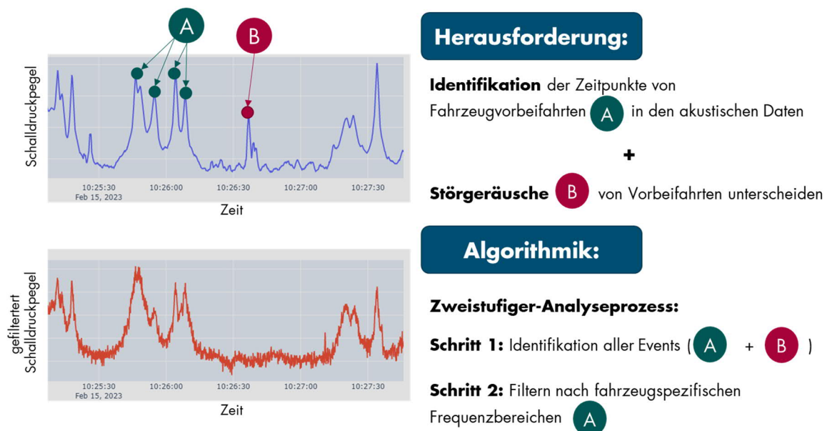
Abbildung 5: Methodik zur Detektion von Vorbeifahrten und Filterung von Störgeräuschen. Im gefilterten Schalldruckpegelverlauf (unten) ist der Peak des Störgeräuschs B (oben) nicht mehr enthalten.
