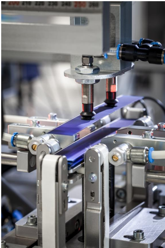
Abbildung 29: (Links) Schindelzellen während der Entnahme aus dem Magazin. Rechts und links des Zellstapels befinden sich die Anblasdüsen, die eine Vereinzelung der Zellen im Magazin ermöglichen. (Rechts) Ablageachse und Ablageboxen für die Sortierung von Schindelzellen in 6 BIN-Klassen.
